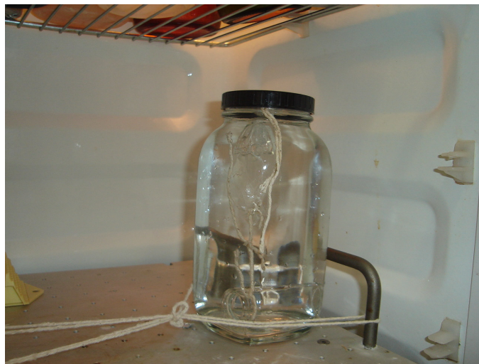
Figura 2. Diálise de conjugado contra água destilada à 4 °C com duas trocas diárias durante 72 horas.
