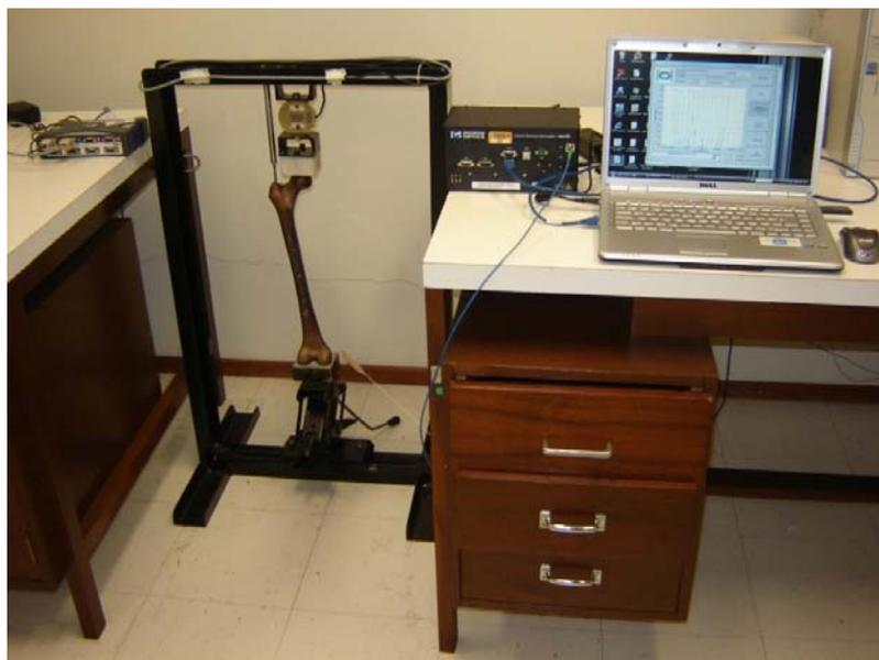
Figura 9: Arranjo de ensaio e instrumentação do fêmur
