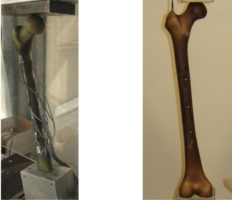
Figura 10: Comparação entre a utilização de extensômetros elétricos e óticos.
