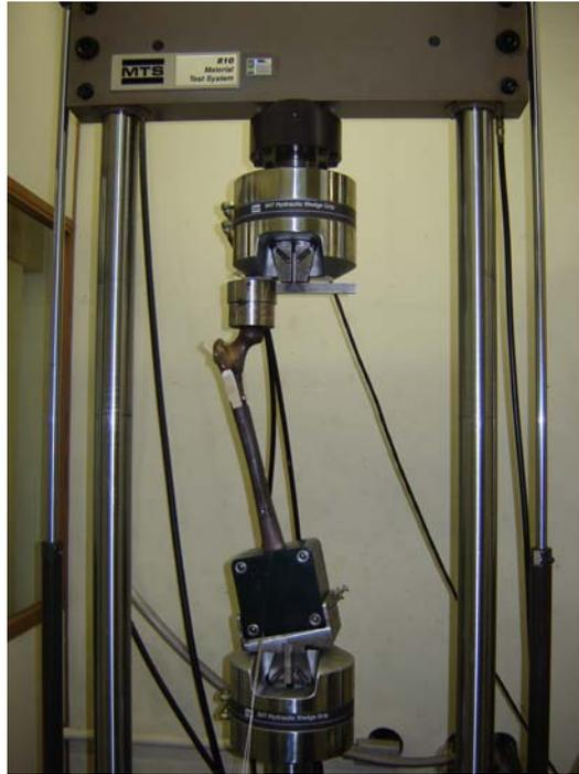
Figura 8: Base e encaixe superior posicionados na máquina universal de ensaios.
