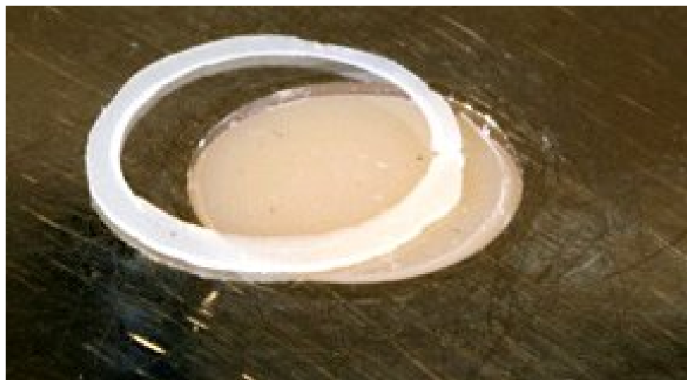
Figura 25 - Excesso de resina fraturado
