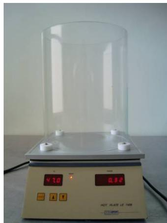
**Figura 12** – Aparelho de placa quente.
