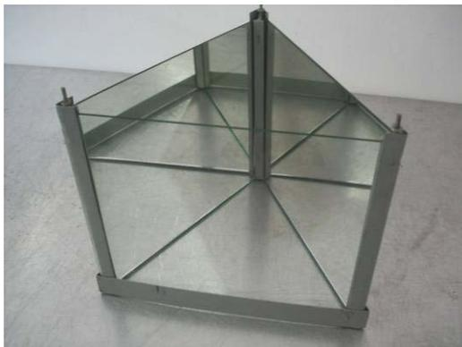
**Figura 13A** – Visão superior da caixa de observação para o teste da formalina.
