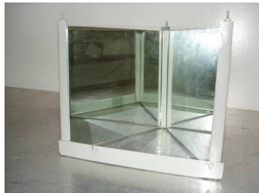
**Figura 13B** – Visão frontal da caixa de observação para o teste da formalina.
