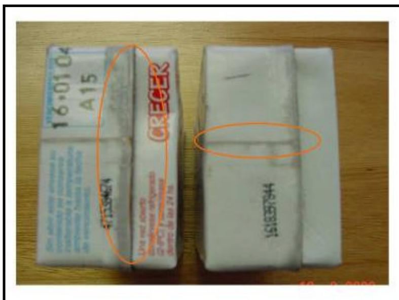
Figura 3.4 – Fenômeno de Edge Soaking
