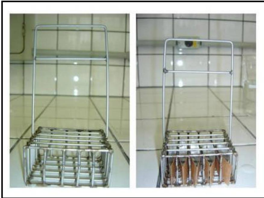
Figura 4.13 – Suporte 4 vazio, e com dez corpos-de-prova.
