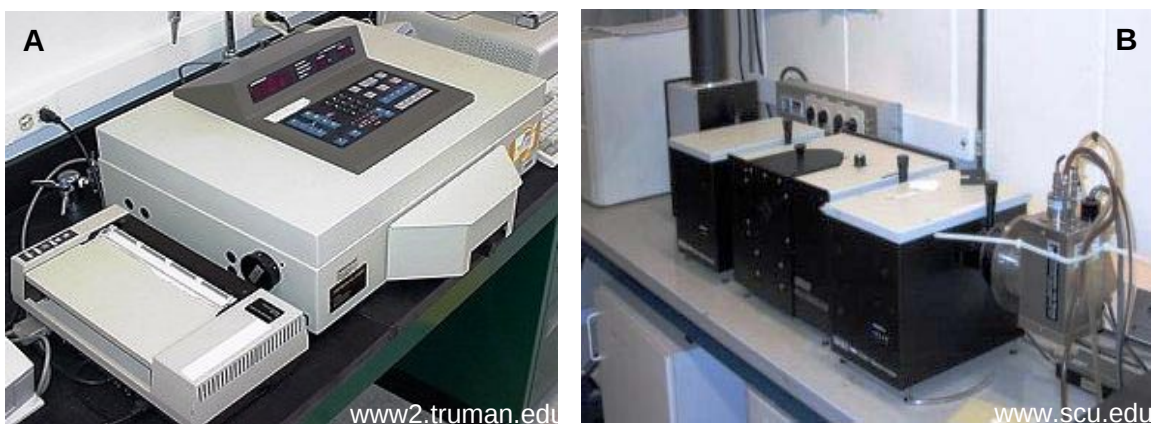
Figura 11. Fotos do espectrofluorímetro modelo LS-5B (A) e do fluorímetro SPEX (B).
