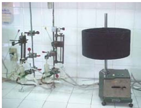
Figura 9. Foto do quimógrafo com cilindro esfumaçado e sistema de cubas.
