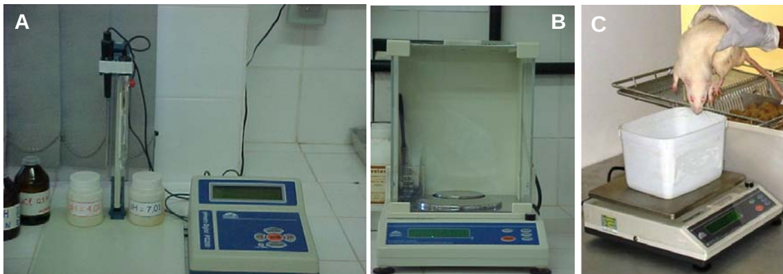
Figura 10. Fotos do pHmetro digital (A), da balança analítica (B) e da balança semi-analítica (C).
