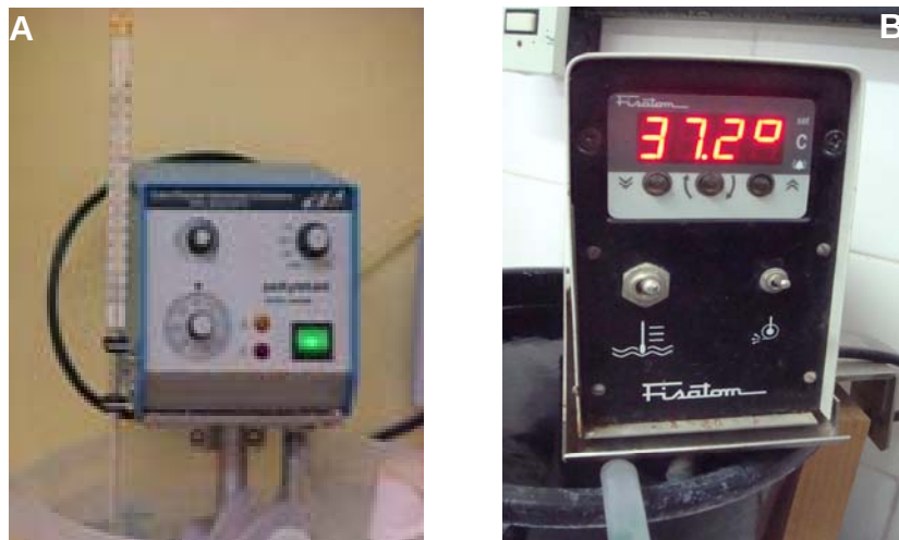
Figura 7. Fotos das bombas termostáticas. Polystat 12002 (A) e Fisatom 597 (B).
