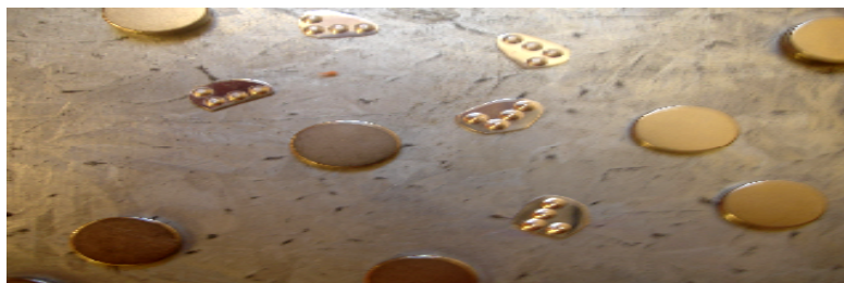
Foto VII.6: Ímãs e recortes de alumínio ainda não colados sobre a placa ferromagnética.
