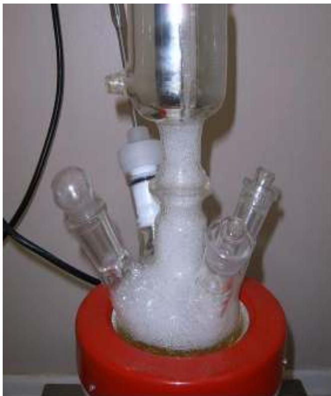
Figura 4.9: Ebulição do óleo de citronela na coluna de fracionamento com formação de espuma.
