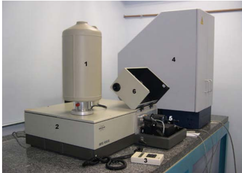
Figura 19 - FT-Raman RFS 100, Bruker. (1) detector de Germânio resfriado por nitrogênio líquido, (2) caixa óptica – corpo do equipamento, (3) estágio motorizado controlador do eixos X, Y e Z do porta-amostra do equipamento, (4) micro-Raman, (5) porta-amostra (6) câmara do porta-amostra (MORENO, 2006).
