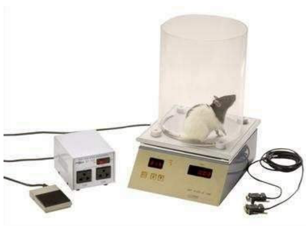
Figura 10 – Aparelho de placa quente. Ugo Basile, modelo LE 7406, Itália.
