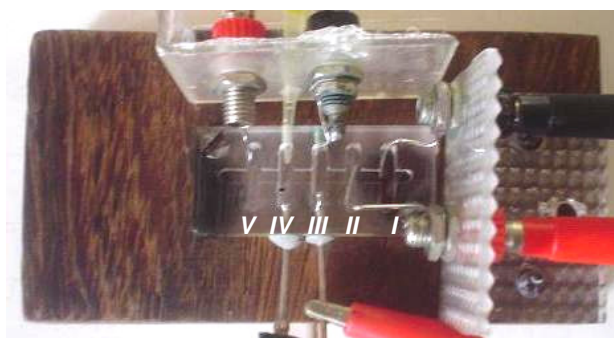
Figura 13 – Câmara experimental para captação dos PAC's. Os cinco compartimentos (I – V) que formam a câmara, de acrílico (centro) sob o suporte de madeira, estão indicados na figura.
