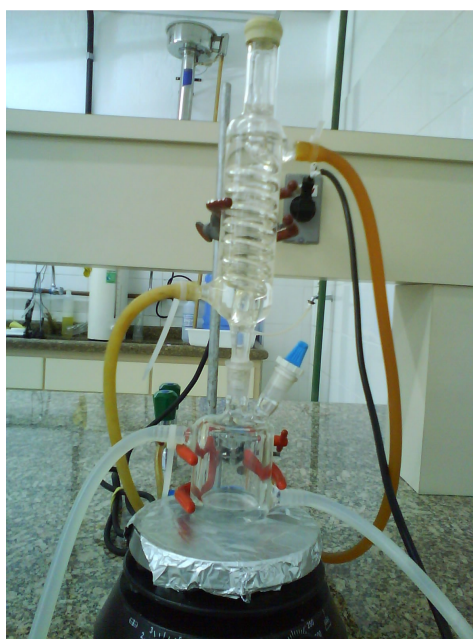
Figura 3.1. Reator de vidro utilizado para síntese de biodiesel nos testes de triagem da fonte de lipase.
