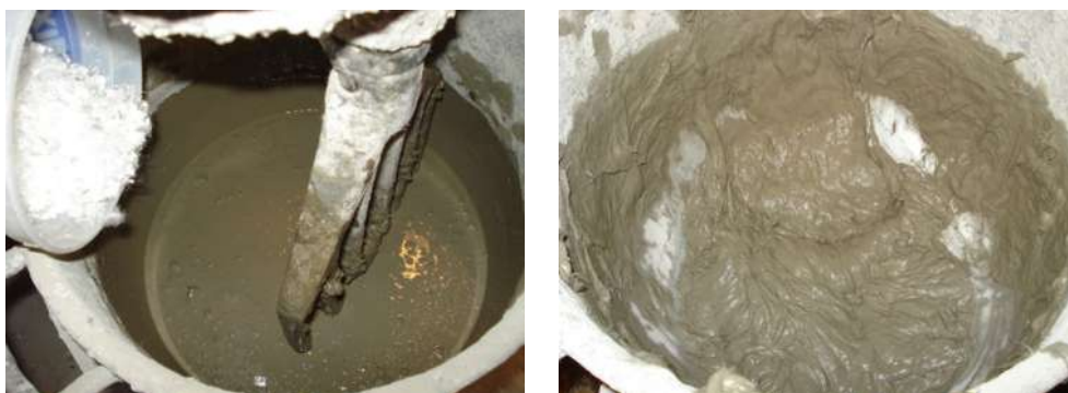
Figura 6.2: PPECC 5 produzido com cimento tipo I: (a) antes e (b) após a adição das fibras.
