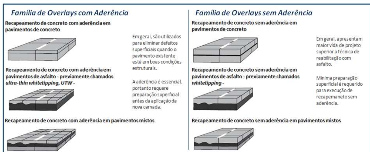
Figura 3.2: Esquema representativo dos tipos de overlay de concreto. [fonte: CP Tech Center, 2007]
