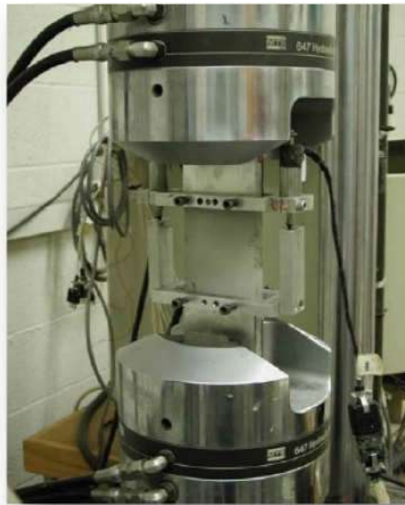
Figura 4.4: Configuração do ensaio de tração uniaxial direta.
