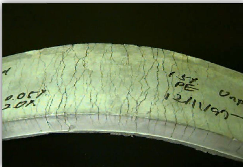
Figura 2.2: Aspecto do padrão de fissuração de um compósito tipo PE-ECC submetido à flexão [fonte: Li e Kanda, 1998]
