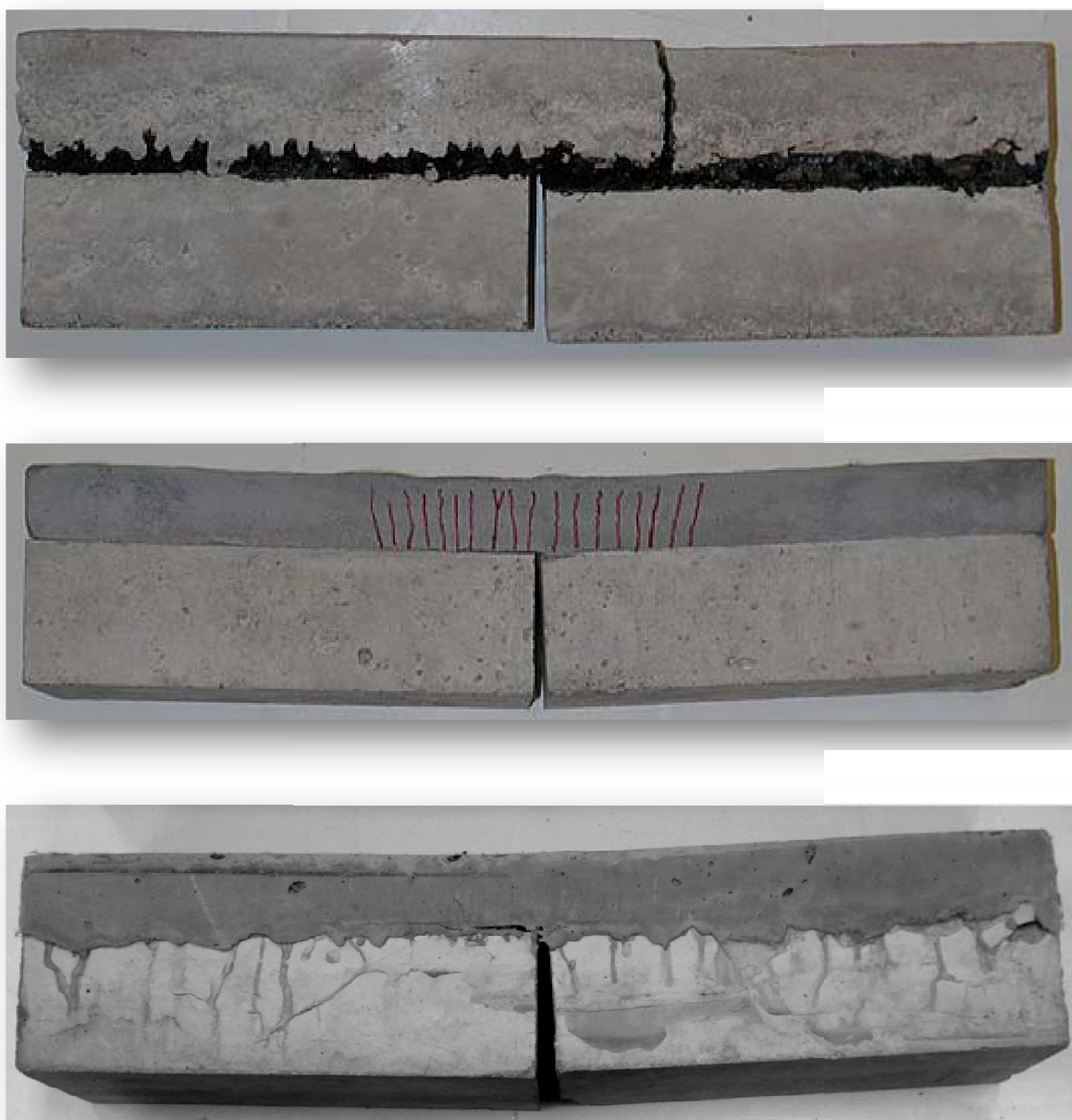
Figura 7.4: Comparação do padrão de fissuração dos recapeamentos de concreto, PVAECC e PPECC sob carregamento monotônico de flexão.
