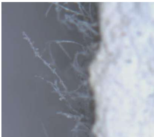
Figura 6.8: Seção de ruptura da viga produzida com compósito PPECC 1 submetida à fadiga com \sigma_{\text{máx}}/\sigma_{\text{ult}} igual a 0,6.
