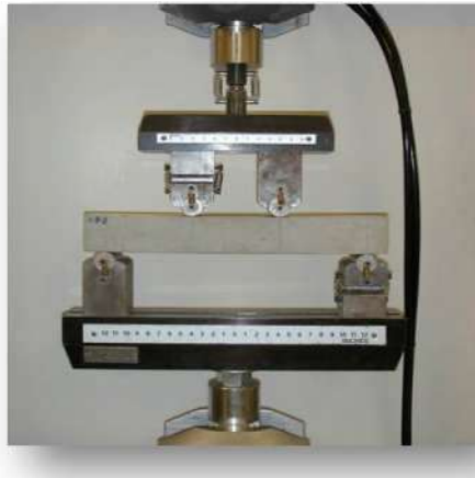
Figura 4.6: Configuração do teste de flexão a quatro pontos
