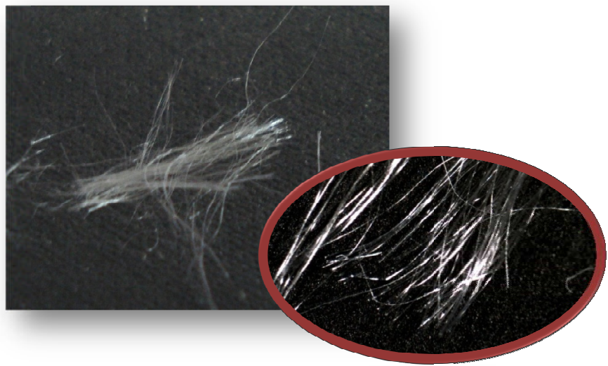
Figura 4.2: Fibras de polipropileno de alta tenacidade utilizadas no programa experimental, de comprimento igual a 10 mm e diâmetro de 12 \mu\text{m}
