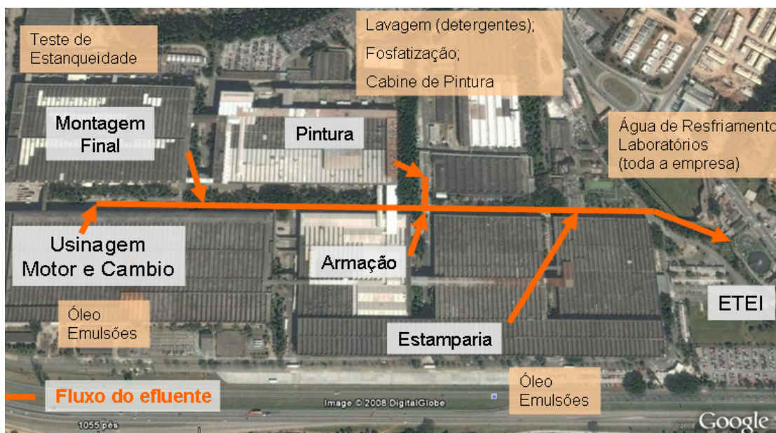
Figura 17: Fluxo dos principais geradores de efluentes, foto adaptada de Google Earth (acessado em 05/10/2008)
