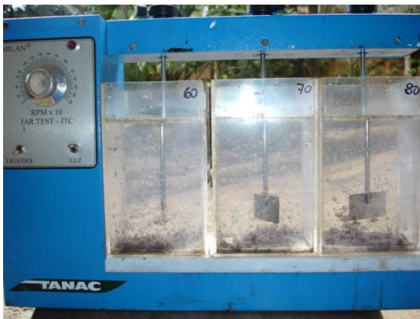
Figura 25: Teste de Tratabilidade – Teste do Jarro
