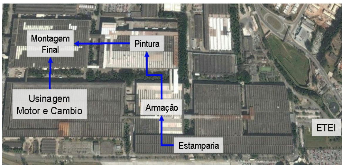
Figura 16: Fluxo produtivo da Volkswagen Anchieta, foto adaptada de Google Earth (acessado em 05/10/2008)
