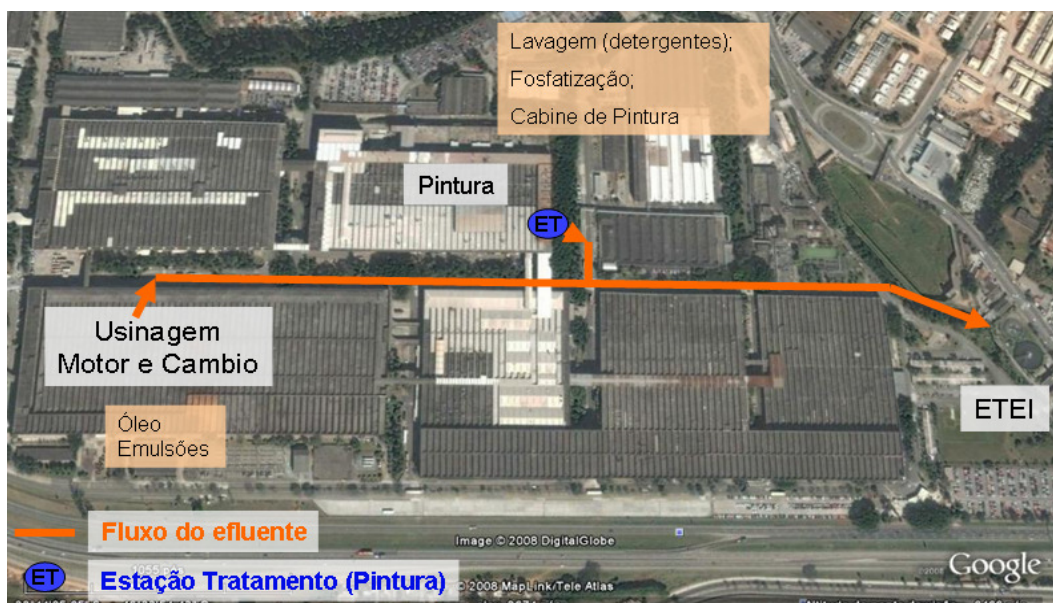
Figura 37: Proposta de implantação de uma ET – Estação de Tratamento na saída do processo de Pintura, foto adaptada de Google Earth (acessado em 05/10/2008)
