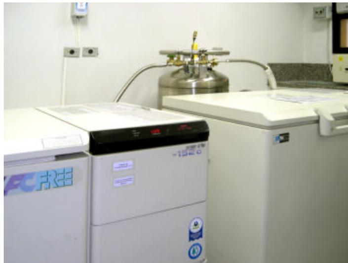
Figura 7 – Congeladores de estocagem de enxertos criopreservados. Neste caso, são congeladores mecânicos, que atingem  $-150^{\circ}\text{C}$ , acoplados a um cilindro de segurança de nitrogênio líquido.
