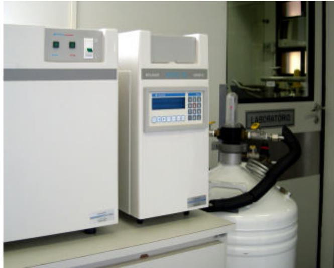
Figura 6 – Câmara de resfriamento programado, utilizado para congelar os enxertos. Ao seu lado direito pode-se observar o *controller*, onde o programa de criopreservação é acionado, e obtém-se o registro gráfico do resfriamento. O fornecimento de nitrogênio líquido é feito pelo cilindro através da válvula solenóide.
