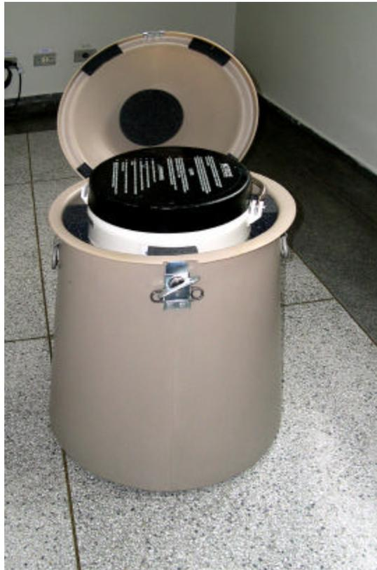
Figura 8 – Equipamento *cryoshipper* utilizado para o transporte de materiais criogênicos, a temperaturas abaixo de  $-130^{\circ}\text{C}$ .
