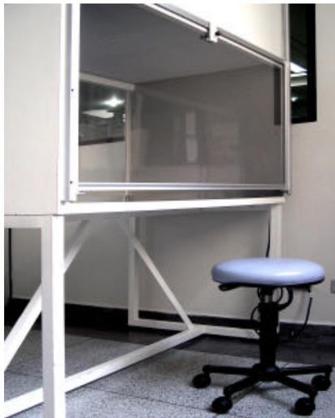
Figura 2 - Cabine de fluxo laminar vertical, classe 100, onde os enxertos são processados em condições ideais de antissepsia.
