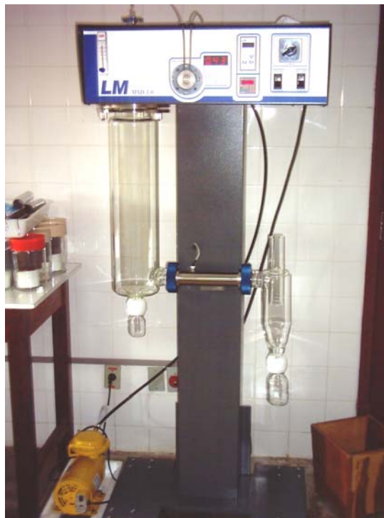
Figura 3.7 – Mini Spray Dryer Labmaq modelo MSD 1.0
