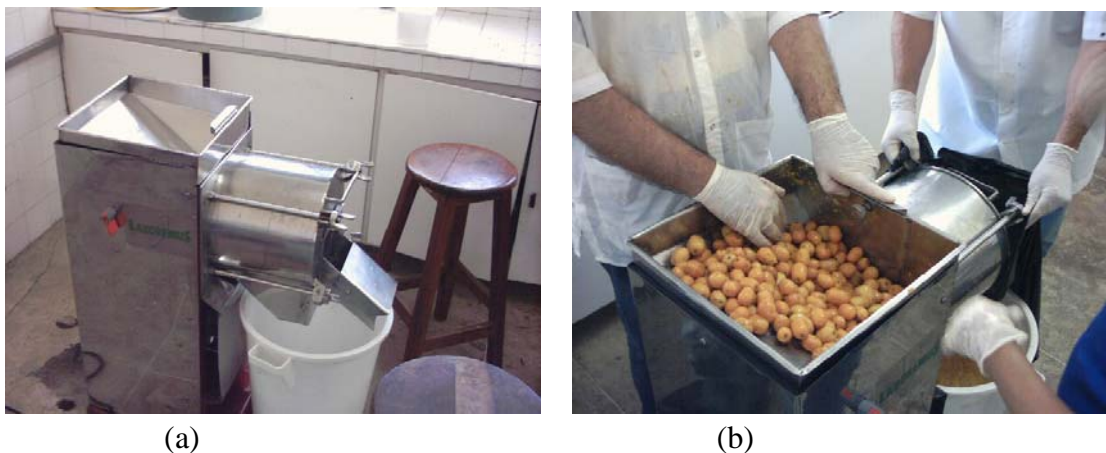
Figura 3.5 – (a) Despoldadeira e (b) processamento dos frutos.
