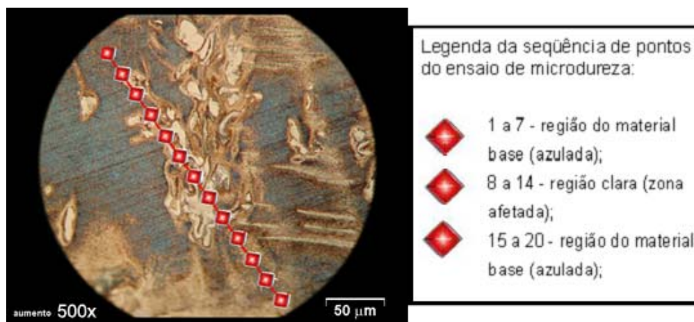
Figura 42 – Ilustração da seqüência de pontos realizados na superfície de corte do Ti-cp (grau 2) usinada a laser com gás nitrogênio (amostra Ticp_laser).
