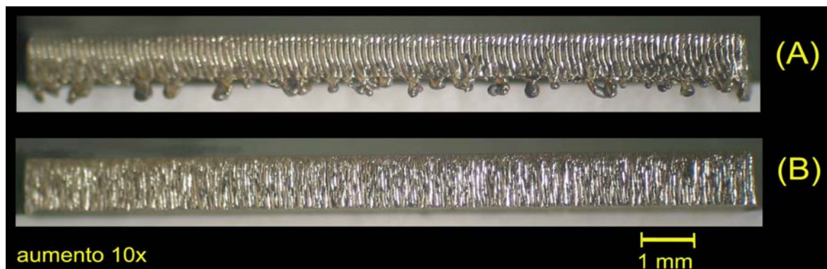
Figura 66 – Fotografia da superfície de corte (a) na pior condição (b) melhor resultado para DOE com 4 fatores.
