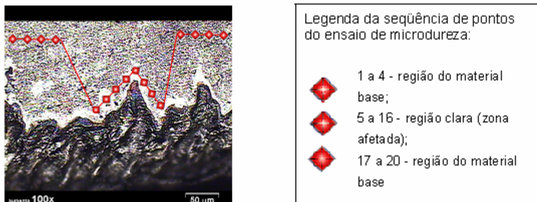
Figura 44 – Ilustração da seqüência de pontos realizados na superfície de corte da liga Ti-6Al-4V usinada a laser com gás nitrogênio (amostra Ti64laser).
