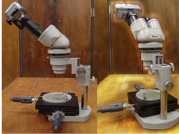
Figura 31 – Foto da configuração do equipamento para capturar a imagem das amostras.
