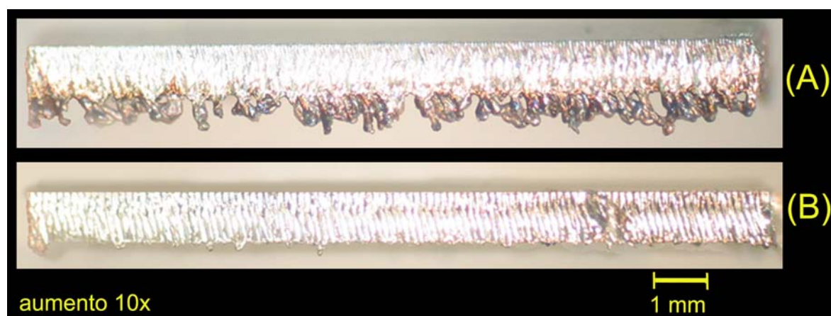
Figura 62 – Aderência de rebarba na borda de corte (a) na pior condição (b) melhor resultado para DOE com 6 fatores.
