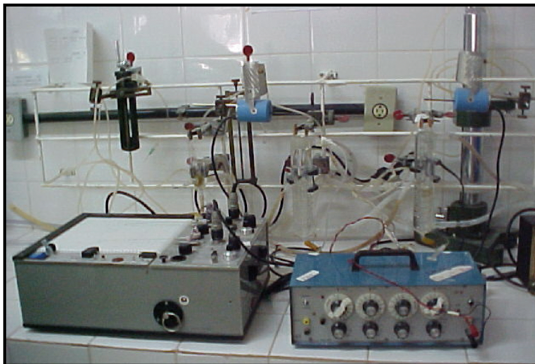
Figura 5- Aparato utilizado para aquisição de dados do cronotropismo cardíaco em átrio direito isolado de rato.
