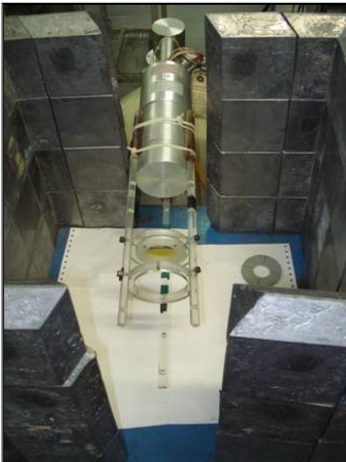
**FIGURA 5-** Arranjo com detector de HPGe
