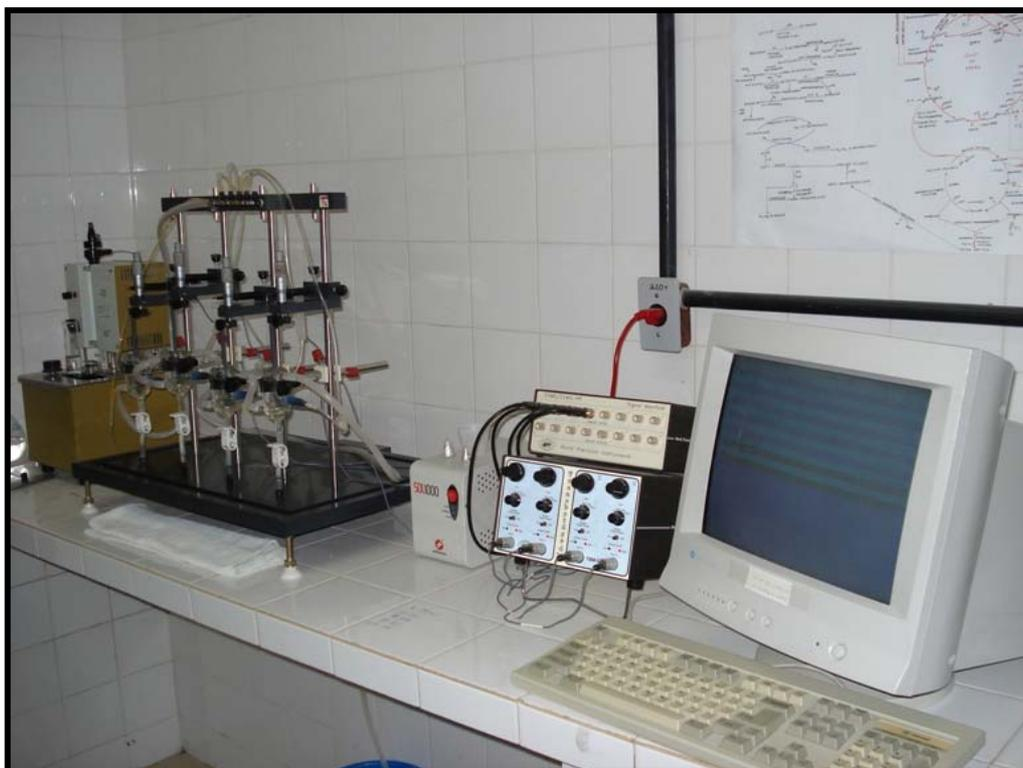
**Figura 4:** Aparato utilizado para os experimentos com anéis de artéria mesentérica superior isolada de rato
