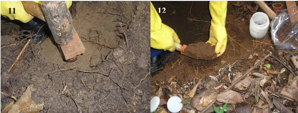
Figura 11. Coleta de solo em anéis volumétricos para análise de porosidade total, macroporosidade, microporosidade e densidade do solo.
