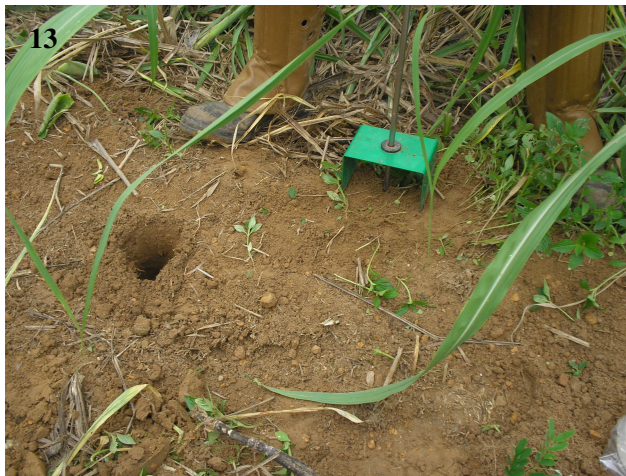
Figura 13. Avaliação da compactação do solo com penetrômetro eletrônico.
