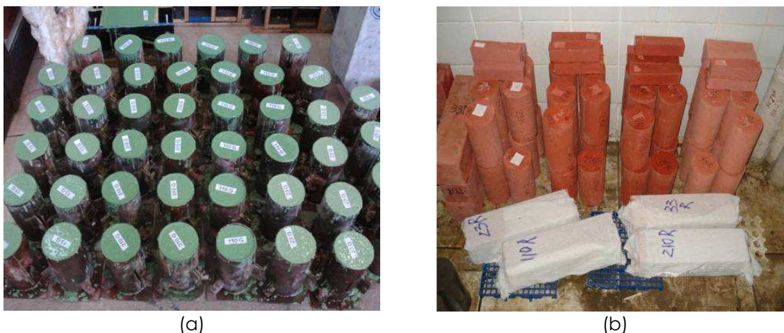
Figura 12 – (a) Corpos-de-prova após a concretagem; (b) Cura dos corpos-de-prova
