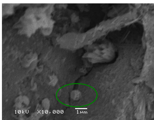
Figura 27 – Grão do pigmento verde não hidratado no concreto
