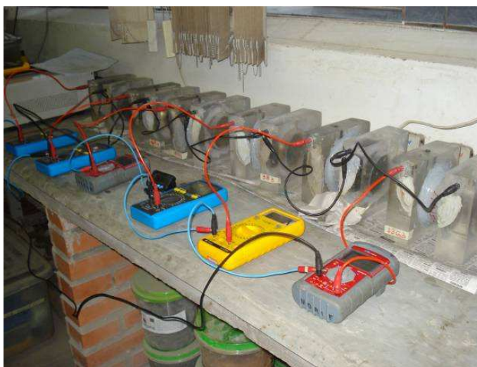
Figura 17 – Ensaio de penetração acelerada de cloretos
