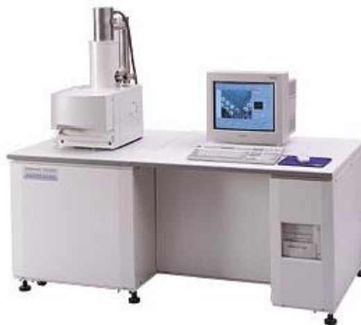
Figura 11: Foto do Microscópio Eletrônico de Varredura (MEV) SS550 usado no Complexo Centrais de Apoio a Pesquisa (COMCAP).
