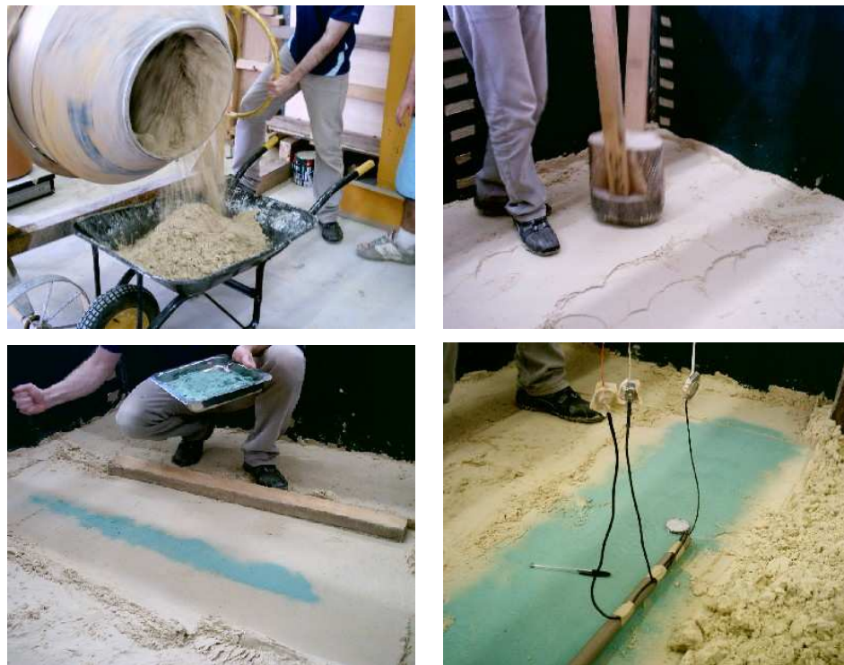
Figura 3.16: detalhes da execução das camadas de solo
