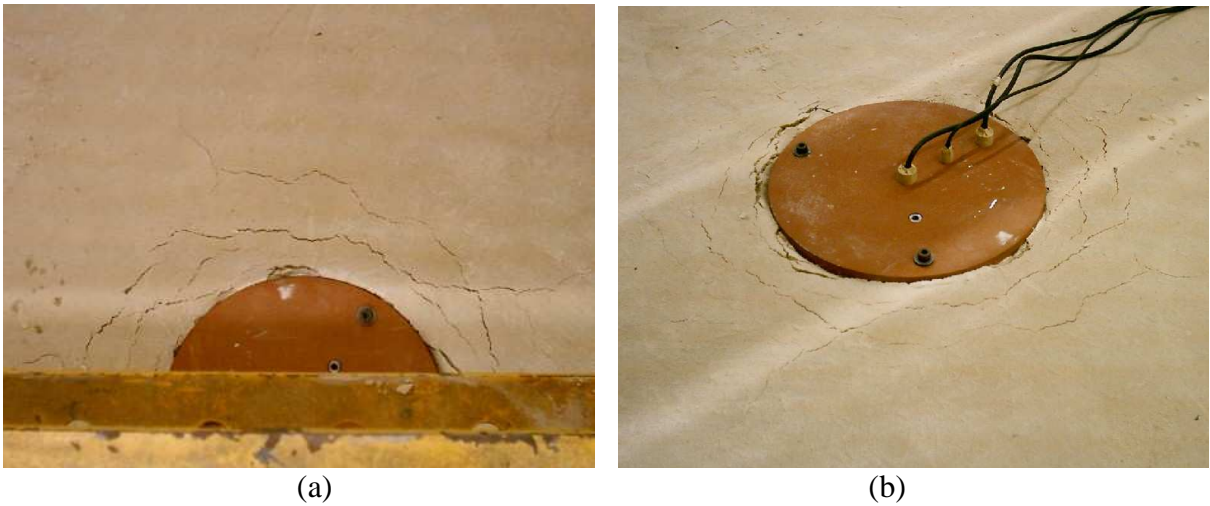
Figura 4.24: mecanismo de ruptura obtido para camadas de areia com 0,25 % de fibras: (a) vista superior e (b) vista lateral
