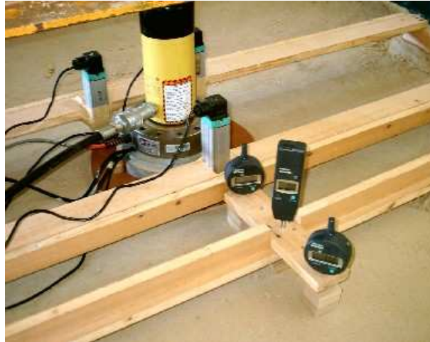
Figura 3.14: sistema de medição de deslocamentos
