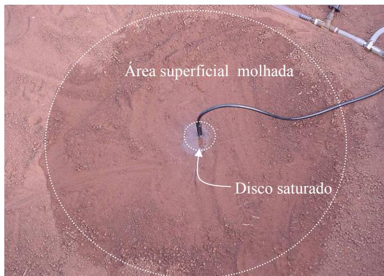
Figura 11 - Processo de medição do disco saturado e frente de umedecimento
