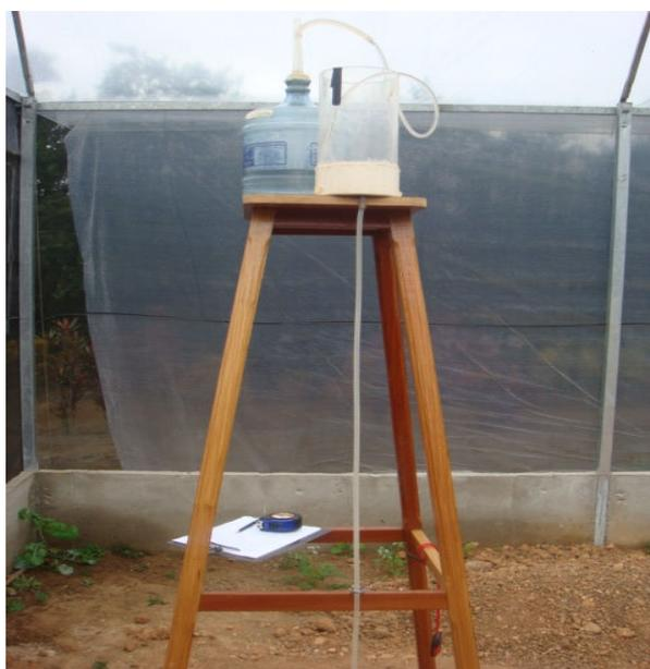
Figura 6 – Sistema de frasco de Mariote utilizado no ensaio
