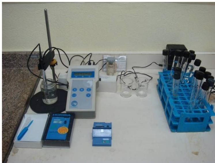
Figura 9 – Medidas de condutividade elétrica do extrato de saturação
