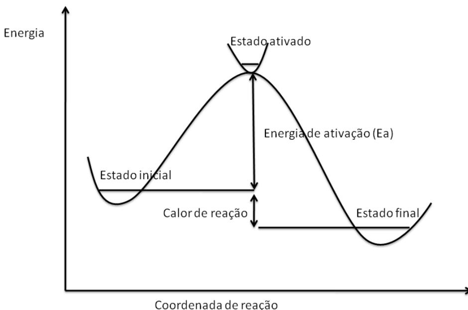
**Esquema 3.2.** Perfil energético de uma reação bimolecular.
