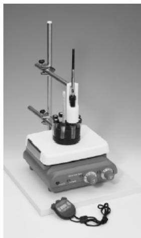
Figura 06 - Equipamento básico para SPME, composto de seringa acoplada à fibra retrátil, suporte, frasco, cronômetro e placa de aquecimento com agitação magnética.
