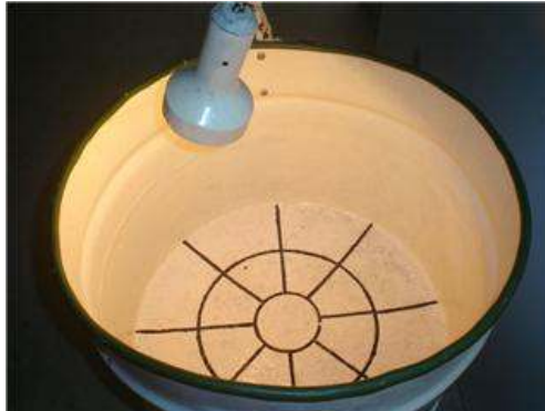
Figura 10 - Plano superior do aparelho do campo aberto, detalhando a arena
