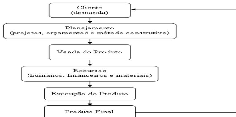
Figura 5 – Fluxograma simplificado do processo produtivo da construção civil
