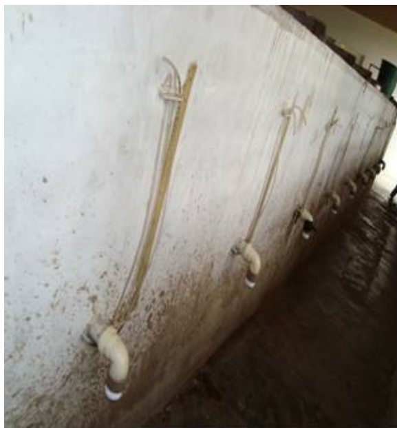
Figuras 13 e 14 Réguas graduadas instaladas paralelamente aos piezômetros
