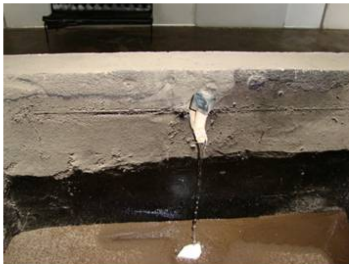
Figura 12 enchimento dos tanques com água residuária previamente bombeada para a caída d'água.
