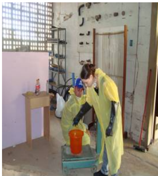
Figuras 16 e 17 Pesagem do volume drenado em cada tanque
