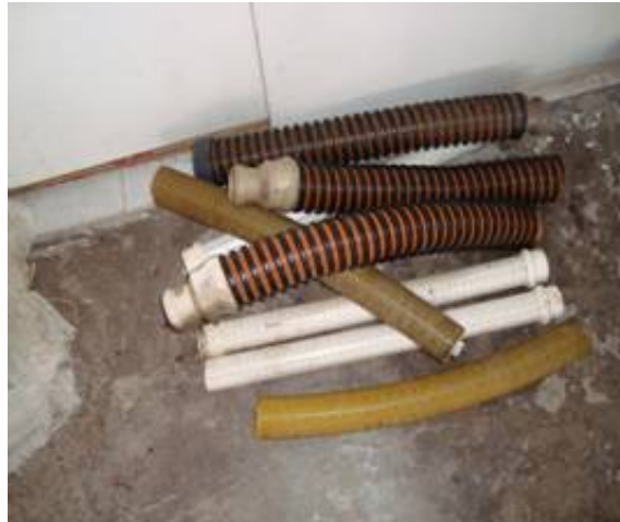
Figura 6 Tubos Drenantes (Drenoflex, PVC liso para esgoto e Kananet) antes de se colocar o envoltório.
