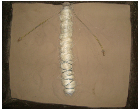
Figura 7 e Figura 8 Tubos Drenantes com o envoltório sisal e Montagem do tubo dentro do tanque, depois de colocado o solo
