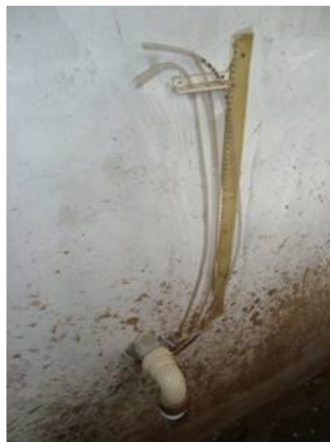
Figuras 13 e 14 Réguas graduadas instaladas paralelamente aos piezômetros
