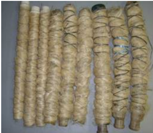
Figura 7 e Figura 8 Tubos Drenantes com o envoltório sisal e Montagem do tubo dentro do tanque, depois de colocado o solo
