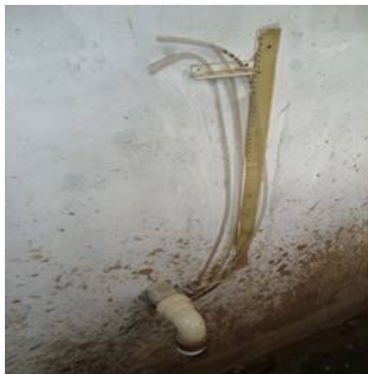
Figura 3 Piezômetro para avaliar as cargas hidráulicas no interior e na vizinhança do sistema de drenagem
