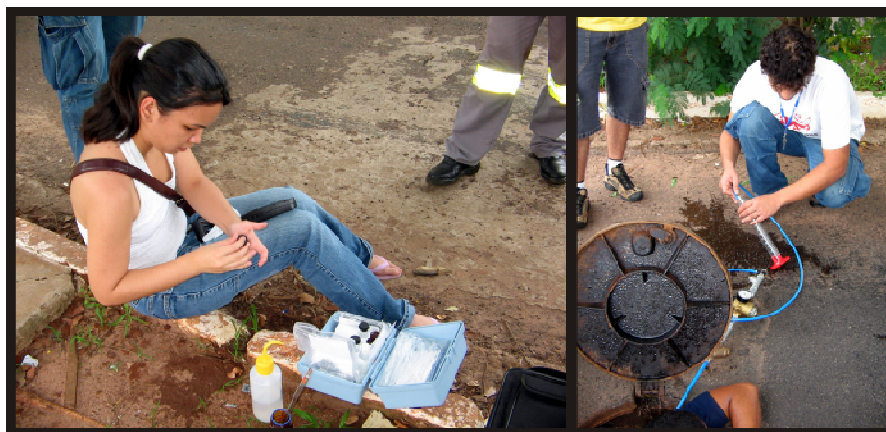
Figura 5.30 - Verificação da concentração de cloro e vazão.
