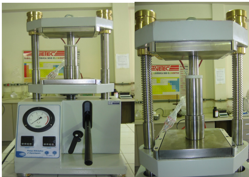
Figura 14. Aparato completo da extração: extrator e prensa hidráulica
