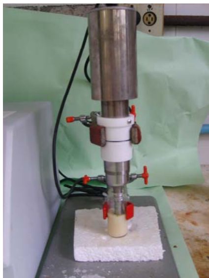
Figura 3. Aparelho de ultrassom modelo VC 500, serial No 480357, 500Watts, frequência 20KHz, 220 Voltz. a) foto geral da reação em ultrassom; b) foto ampliada utilizando um probe de 13mm (1/2 polegada, volume de 10-250 mL, intensidade alta, amplitude superior a 100, comprimento 139 mm); c) foto ampliada da reação usando um probe com microtip cônico de 3mm (1/8 polegada (630-0418), volume de 1-10mL, intensidade ultra alta, amplitude máxima 40%, comprimento 159 mm).
