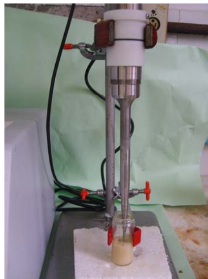
Figura 3. Aparelho de ultrassom modelo VC 500, serial No 480357, 500Watts, frequência 20KHz, 220 Voltz. a) foto geral da reação em ultrassom; b) foto ampliada utilizando um probe de 13mm (1/2 polegada, volume de 10-250 mL, intensidade alta, amplitude superior a 100, comprimento 139 mm); c) foto ampliada da reação usando um probe com microtip cônico de 3mm (1/8 polegada (630-0418), volume de 1-10mL, intensidade ultra alta, amplitude máxima 40%, comprimento 159 mm).
