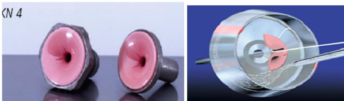
Figura 12 - à esquerda foto do funil de saída KN4 da Belcoro; à direita. Ilustração do processo de formação do fio na fiação a rotor. Fonte: (SCHLAFHORST, 2004)
