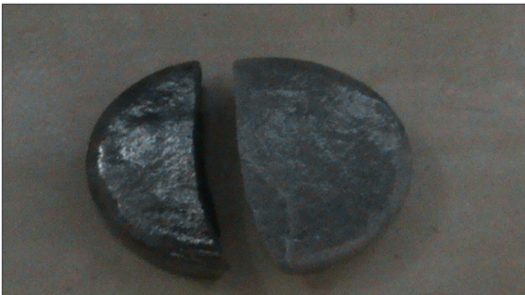
Figura 26 – Amostra fraturada após ensaio de compressão diametral.
