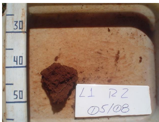
Figura 4 – Torrão com tamanho aproximado de 0,15 a 0,20 m e exposição da face onde houve quebra natural de estrutura, utilizado na avaliação visual da porosidade e da cor do solo em relação a variação da cor a partir da testemunha (mata).
