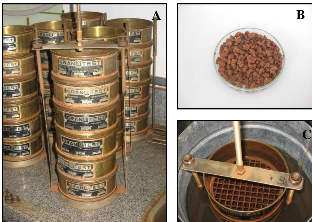
Figura 8 – Determinação da estabilidade de agregados por via úmida. Conjunto de seis peneiras utilizadas no peneiramento (A); Agregados selecionados de tamanho entre 9,52 mm e 4,00 mm (B); Detalhe da peneira superior com diâmetro de 7,93 mm (C).
