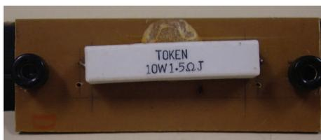
Figura 5.7 – Resistor utilizado para a medição de corrente em alta frequência.
