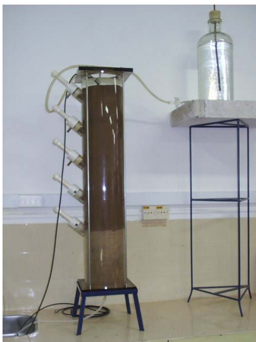
Figura 7 – Saturação do solo mostrando a passagem da água do frasco de Mariotte para a coluna
