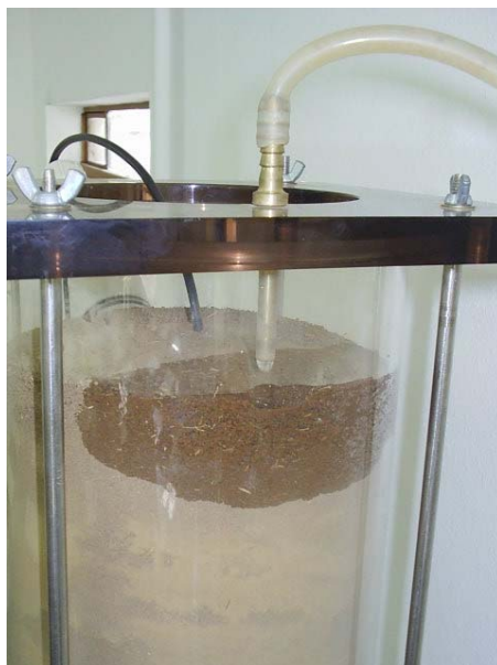
Figura 6 – Início do processo de saturação mostrando a frente de molhamento da coluna de acrílico
