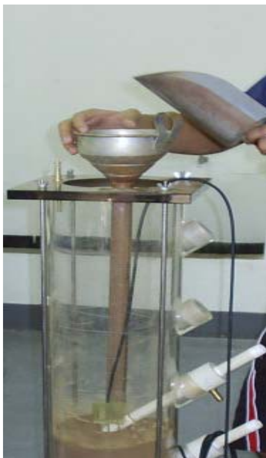
Figura 4 – Utilização do funil com o cano de PVC para a colocação de solo
