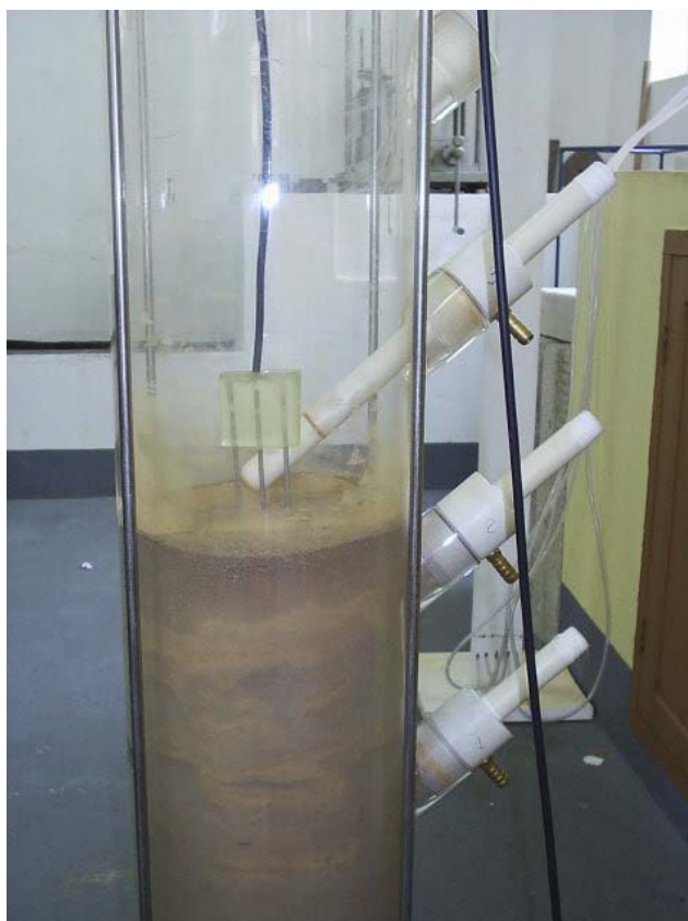
Figura 5 – Sonda de TDR posicionada no centro da coluna
