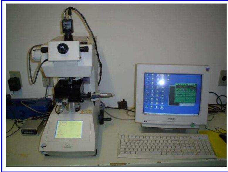
Figura 3.14 – Microdurômetro da marca HMV e computador para tratamento de imagens.
