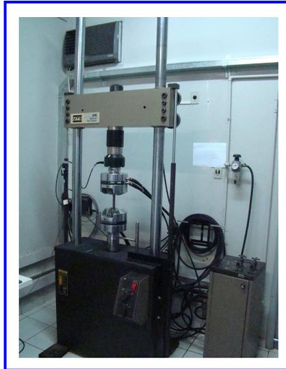
Figura 3.17 – Foto da máquina destinada aos ensaios de ruptura à tração.
