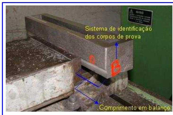
Figura 3.10 – Detalhe do sistema de fixação dos corpos de prova através de uma morsa mecânica.
