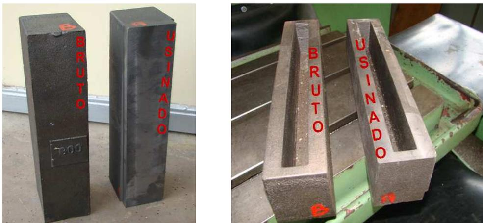
Figura 3.5 – Corpos de prova bruto fundição e usinado na parte inferior e superior.
