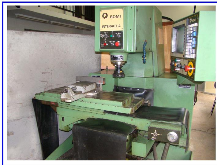
Figura 3.9 – Fresadora INTERACT IV da marca ROMI utilizada nos ensaios de fresamento.
