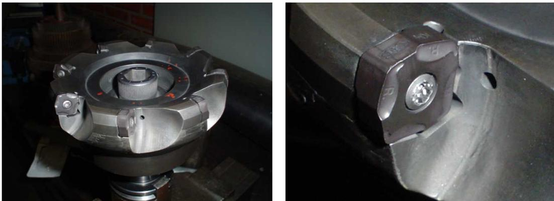
Figura 3.7 – Foto da fresa frontal e da pastilha utilizadas nos testes de usabilidade.
