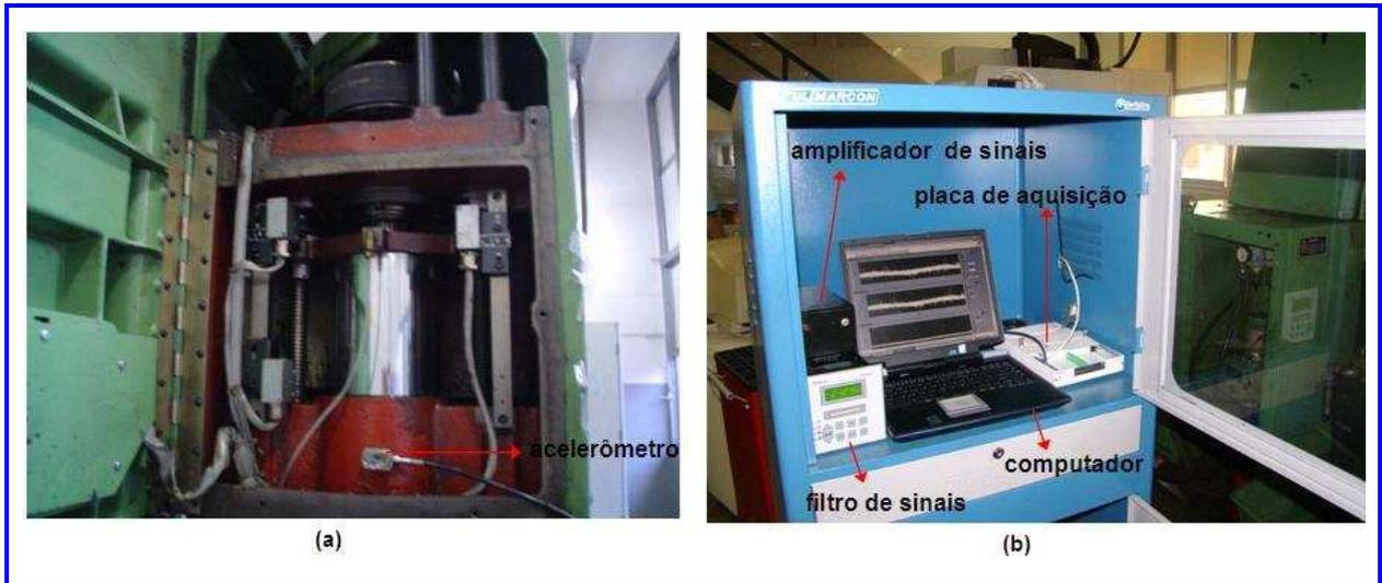
Figura 3.21 – (a) acelerômetro fixado no mancal do eixo-árvore da máquina-ferramenta. (b) sistema de aquisição dos sinais de potência e vibração.
