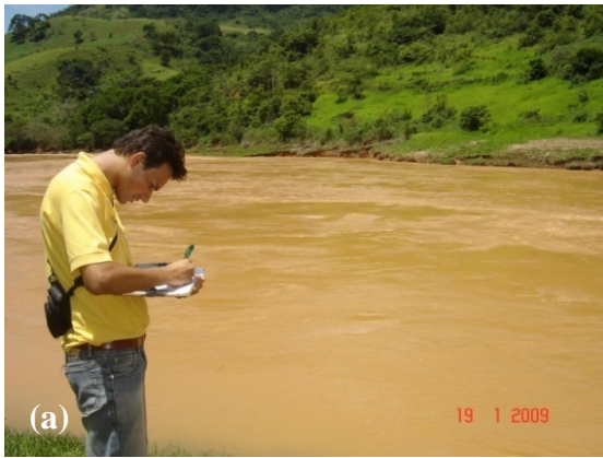
Figura 3.14 – Anotação em formulário próprio dos dados obtidos em campo, como coordenadas geográficas e temperatura da água (a); Início das análises laboratoriais (b) (Imagens obtidas durante a 2ª campanha de campo, em janeiro de 2009).
