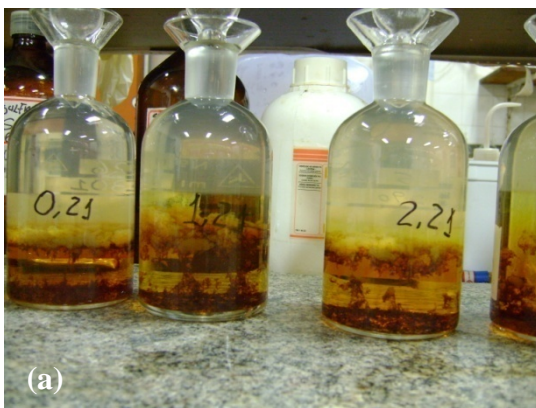
Figura 3.15 – Fixação do oxigênio dissolvido pelo Método de Winkler (a) (Imagem obtida durante a 1ª campanha de campo, em outubro de 2008); Amostras de coliformes termotolerantes (b) (Imagem obtida durante a 2ª campanha de campo, em janeiro de 2009).
