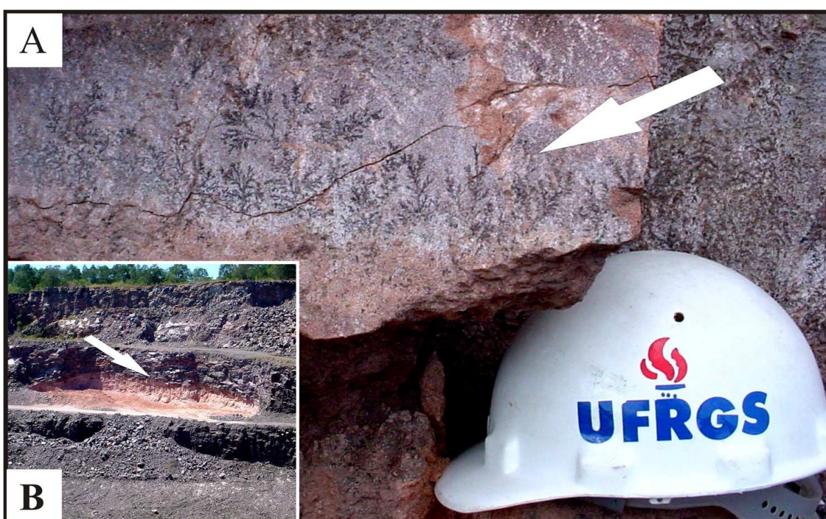
FIGURA 31 - (A) Imagens de dendrites de óxidos e hidróxidos de Mn (seta) em fratura de um arenito localizado (B) no topo de uma duna (seta) da Formação Botucatu capeada por derrames de lava pouco espessos (<1m), indicando a percolação de águas no sentido ascendente. Pedreira Britagem Rio Bonito, 2006. Altura exposta da duna ~8m. Fonte: autor.
