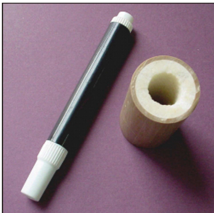
FIGURA 50 - Fragmento serrado de cano de água em PVC com uma polegada de diâmetro parcialmente preenchido pela cristalização de calcita. Provém da região de rochas basálticas no Rio Grande do Sul (Cortesia Prof. Ari Roisenberg - UFRGS). Fonte: autor.
