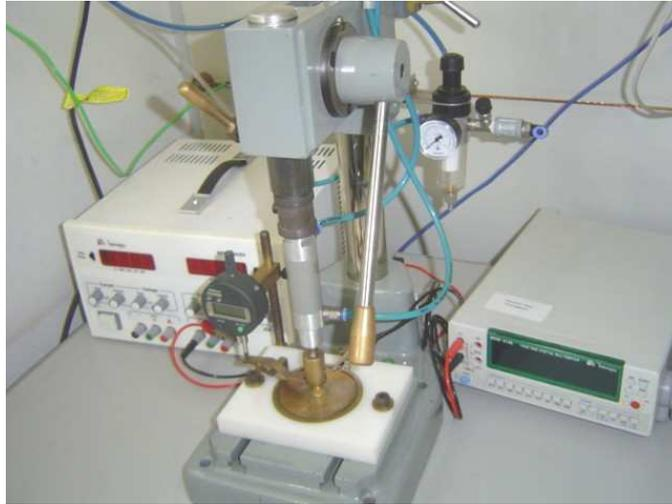
Figura 15 – Fotografia do equipamento utilizado nas medidas de condutividade elétrica volumétrica das amostras.
