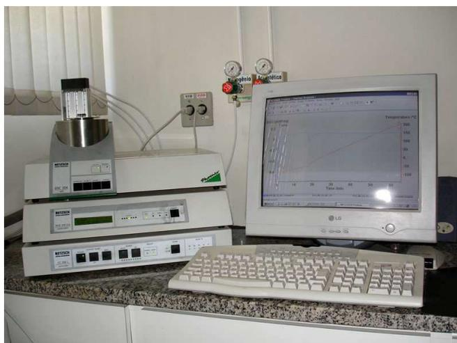
Figura 24 – Foto do equipamento DSC da marca *NETZSCH*, modelo 204.
