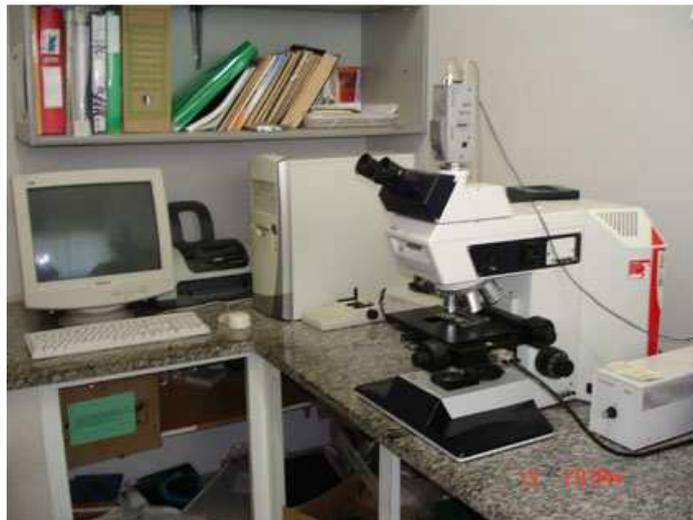
Figura 19 – Microscópio óptico utilizado na microscopia dos compósitos BN/RC/NF.
