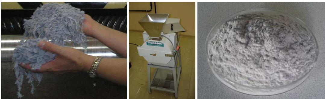
Figura 8 – Processo de trituração da RC utilizada na conformação dos corpos de prova.
