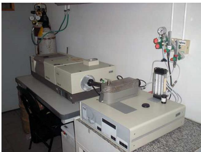
Figura 23 – Equipamento *NETZSCH* modelo (209) acoplado ao espectrômetro FT-IR *Bruker* modelo Vetor 22.
