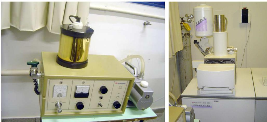
Figura 20 – *Sputter Coater* e Microscópio Eletrônico de Varredura utilizado na microscopia dos compósitos BN/RC/NF.
