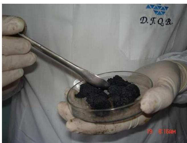
Figura 10 – Processo manual utilizado na conformação dos compósitos BN/RC/NF.
