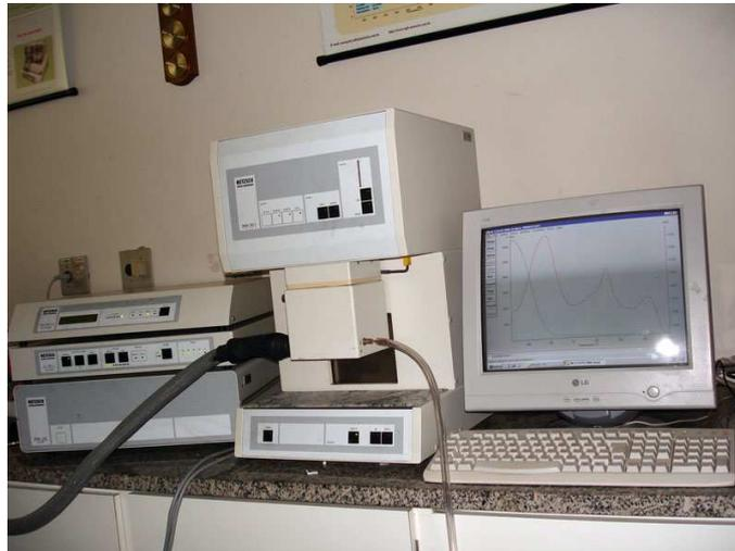
Figura 25 – Equipamento *NETZSCH* modelo DMA 242C.
