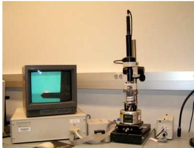
Figura 21 – Microscópio de força atômica utilizado na microscopia dos compósitos BN/RC/NF.
