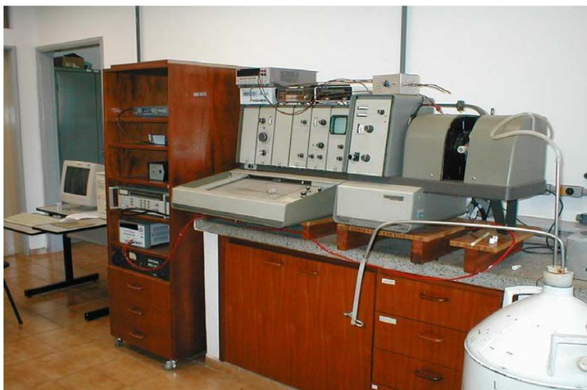
**Figura 13** – Espectrômetro de Ressonância Paramagnética Eletrônica RPE, VARIAN-E4/1969.
