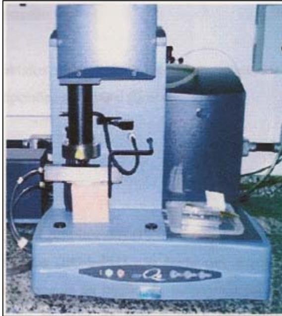
Figura 21: Analisador termogravimétrico
