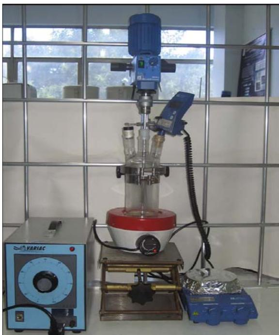
Figura 14 – Aparelhagem utilizada nas sínteses das dispersões aquosas e na deslaminação das argilas hidrofílicas
