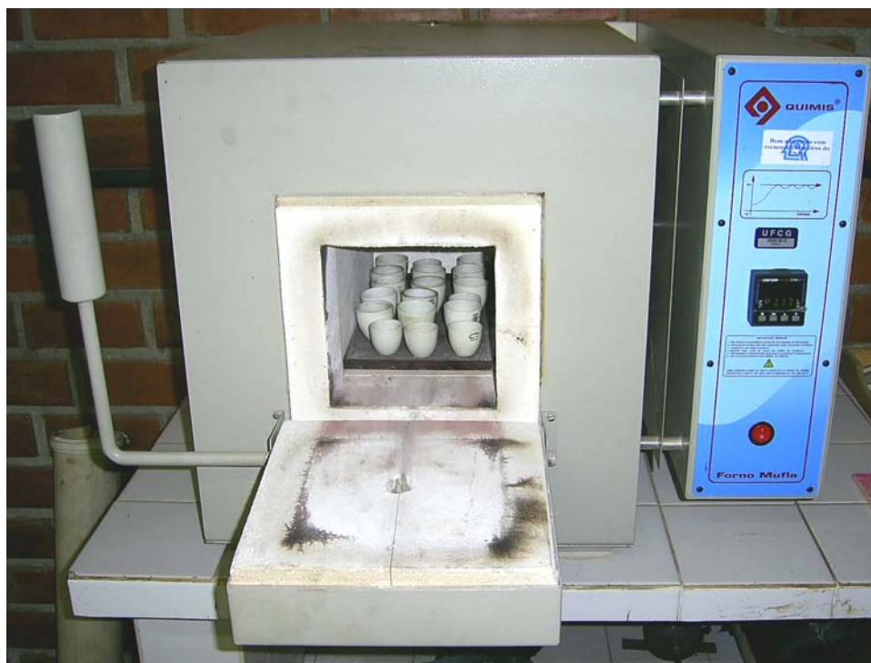
Figura 19 – Corpos-de-prova em cadinhos de porcelana no forno mufla para incineração
