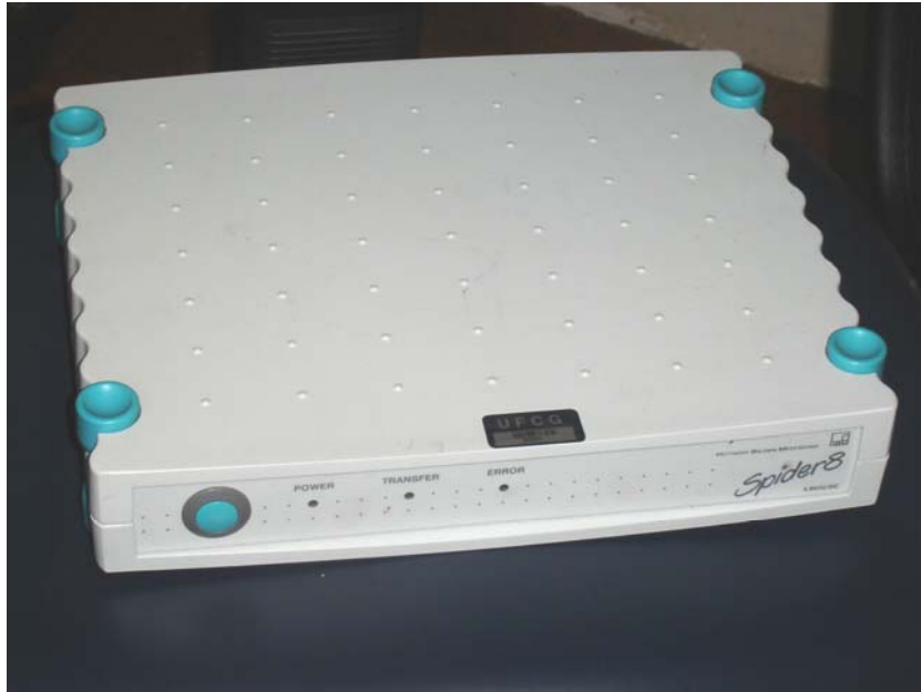
Figura 10 - Aparelho “Spider 8” para aquisição de dados
