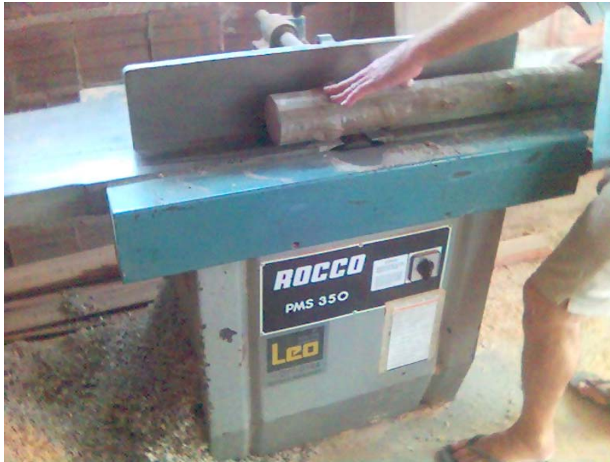
Figura 23 – Esquadreamento das toras em uma plaina
