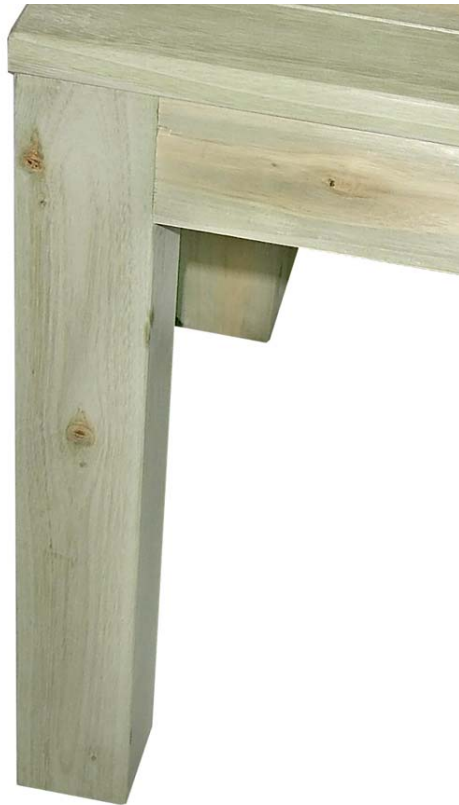
Figura 30 – Detalhe dos nós presentes na madeira
