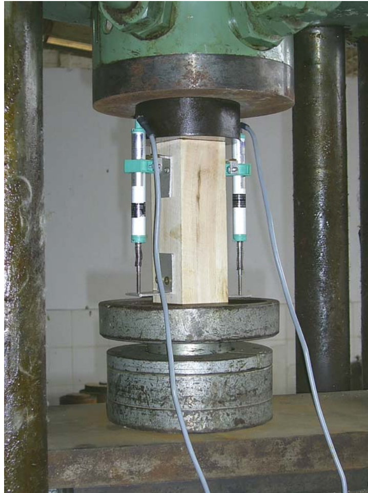
Figura 9 - LVDTs nos lados do corpo-de-prova e detalhes do espaçador e da rótula
