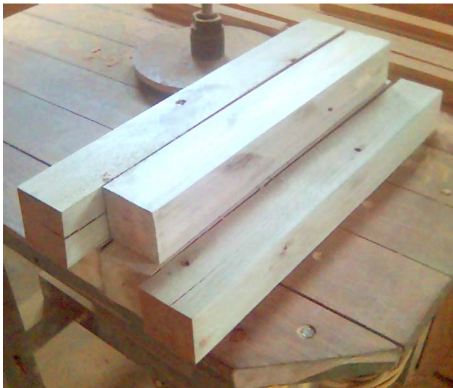
Figura 24 – Peças prismáticas da madeira de E. camaldulensis
