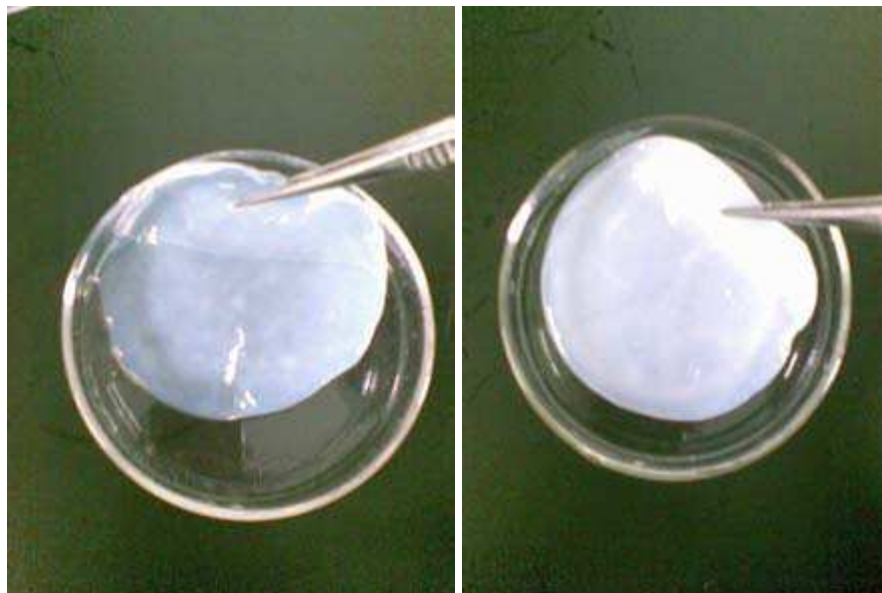
Figura 18 – Imagem da membrana de BC (a) e da membrana de BC contendo nanopartículas de AgCl (b) (HU et al. , 2008)
