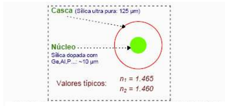
Figura A3: Seção transversal de uma fibra óptica . O núcleo, por onde a luz é conduzida, é cerca de 10 vezes menor que a casca.
