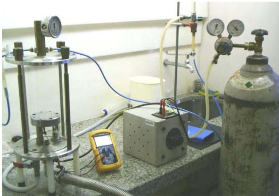
*Figura 3.2: Fotografia da montagem experimental utilizada para produção de filmes finos por spray pyrolysis [39].*
