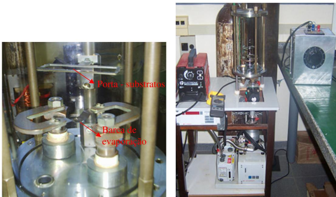
*Figura 3.4: Fotografia da montagem experimental da evaporadora térmica [40].*
