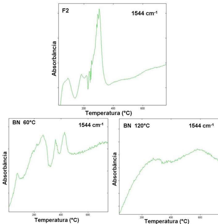
**Figura 35** - Absorbância versus Temperatura (°C), em  $1544\text{ cm}^{-1}$  para a amostra F2 e membranas tratadas a 60 e 120°C.
