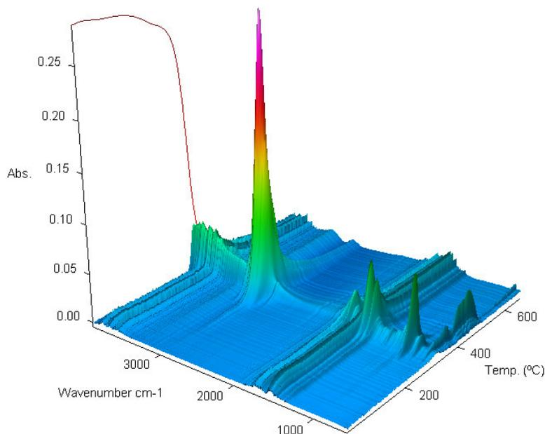
**Figura 29** - Imagem 3D de TG/FT-IR para a membrana de borracha natural obtida a 85°C liofilizada.
