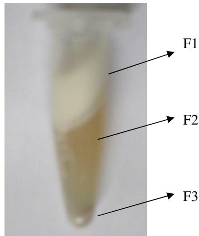
**Figura 4** – *Três fases constituintes do látex centrifugado.*
