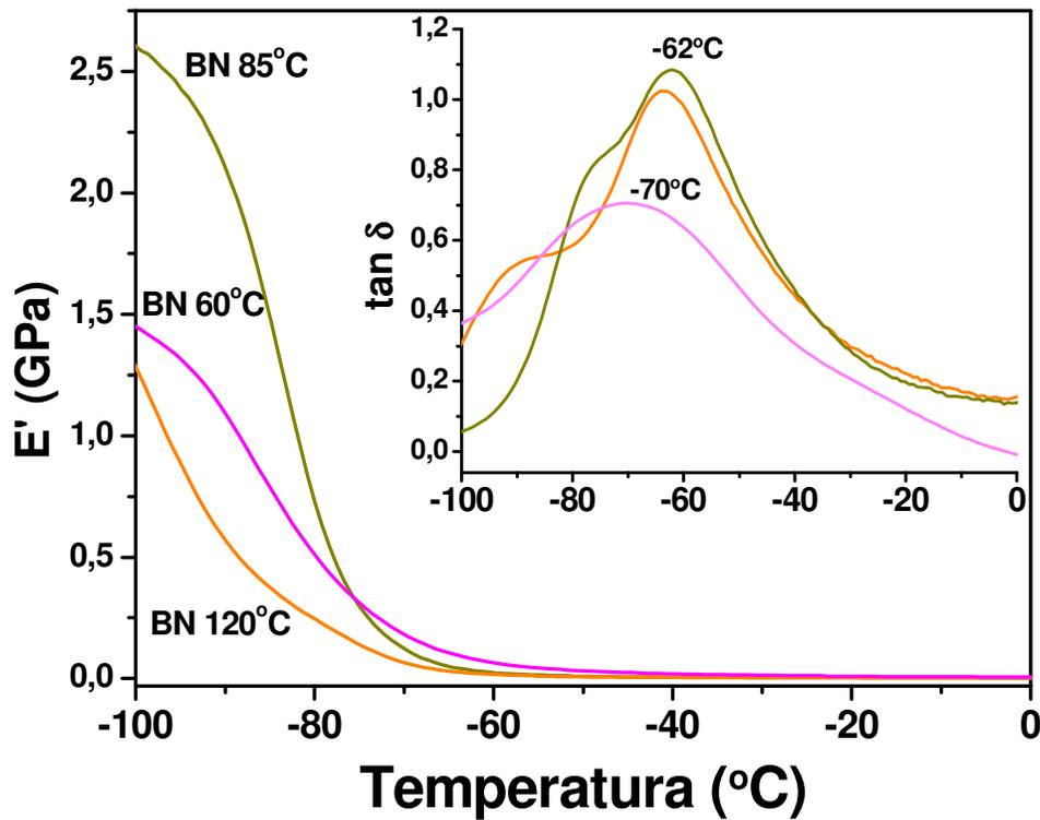
Figura 37 – Curva de DMA das membranas tratada a 60, 85 e 120 $^{\circ}\text{C}$ .
