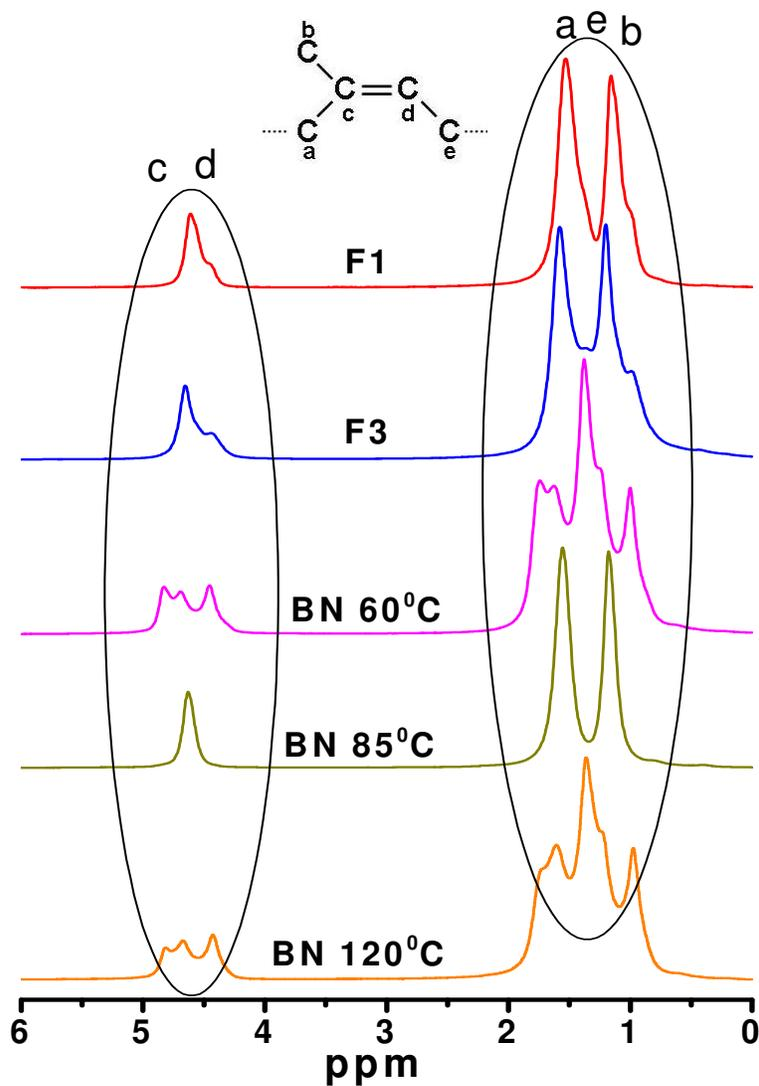
**Figura 12** - Espectro de RMN <sup>1</sup>H das amostras F1, F3 e das membranas tratadas a 60, 85 e 120°C.
