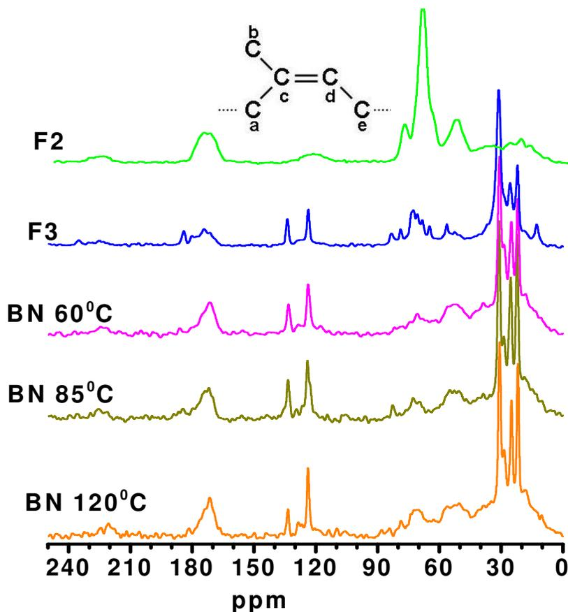
**Figura 11** - Espectro de RMN  $^{13}\text{C}$  CP/MAS das amostras F2, F3 e das membranas tratadas a 60, 85 e 120°C.
