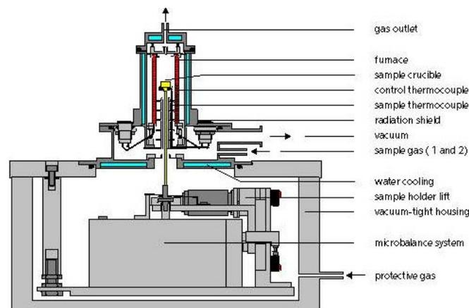
**ANALISADOR TERMOGRAVIMÉTRICO (TG 209)**
