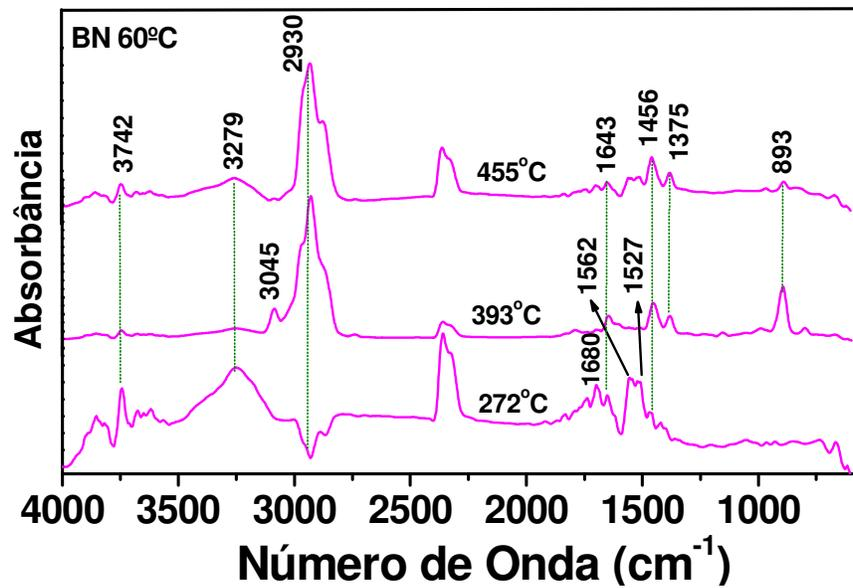
**Figura 28** - Espectros extraídos da imagem de 3D do TG/FT-IR da membrana de borracha natural obtida a 60°C liofilizada.
