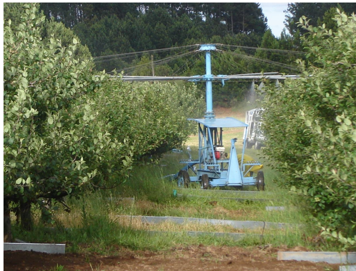
Figura 2 – Vista do simulador de chuvas em operação no tratamento aveia incorporada na enxada (AE), sob as plantas de maçã, em Vacaria – RS.
