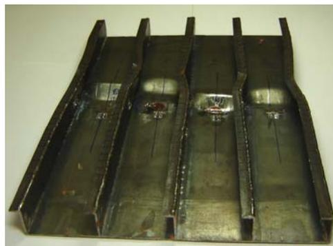
Figura 4.59. Modo de pós-colapso para o modelo experimental – modelo P5B
