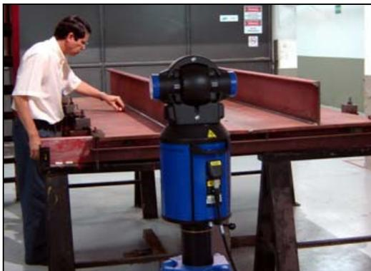
Figura 5.53. Medição de uma superfície com a utilização do equipamento *Laser Tracker*
