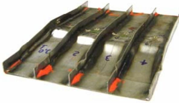
Figura 4.51. Modo de pós-colapso para o modelo experimental – modelo P4
