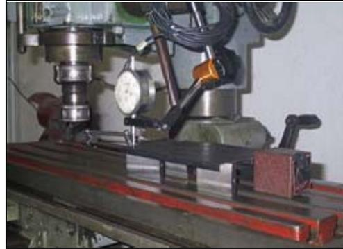
Figura 4.12. Medição das imperfeições geométricas iniciais
