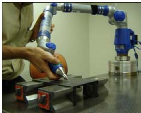
Figura 4.21. Medição das imperfeições geométricas iniciais com o braço portátil
