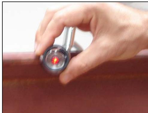
Figura 5.54. Posicionamento da esfera de metal sob o alvo a ser medido
