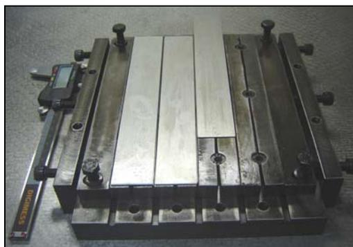
Figura 4.18. Posicionamento das chapas entre reforços no gabarito
