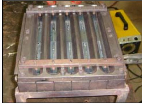
Figura 4.10. Remoção do ajuste central para soldagem
