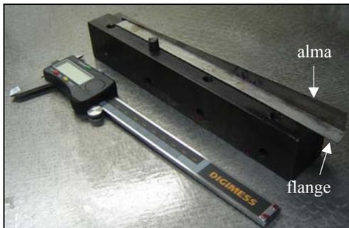
Figura 4.13. Gabarito empregado para a construção do perfil L, posicionamento da alma e do flange
