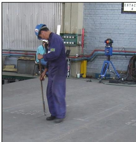
Figura 5.52. Medições das imperfeições geométricas iniciais em painéis enrijecidos com a utilização do equipamento *Laser Tracker*
