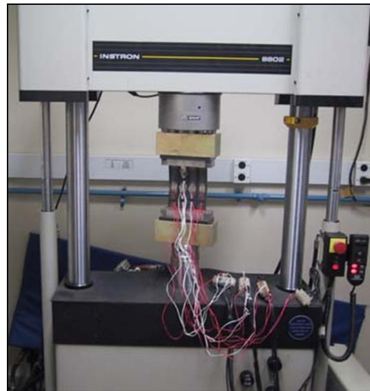
Figura 4.26. Teste de compressão, Instron 8802
