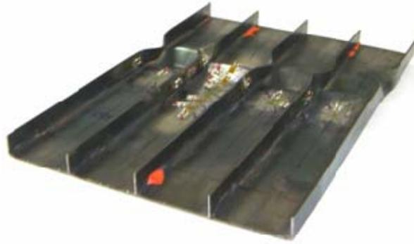
Figura 4.47. Modo de pós-colapso para o modelo experimental – modelo P3
