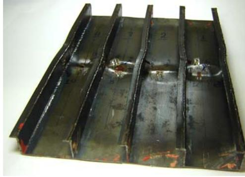
Figura 4.55. Modo de pós-colapso para o modelo experimental – modelo P5A
