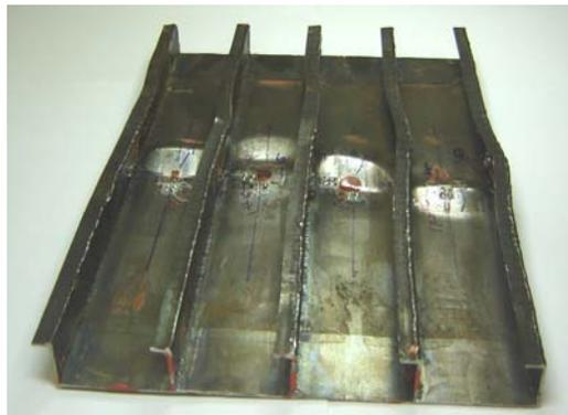
Figura 4.63. Modo de pós-colapso para o modelo experimental – modelo P5C
