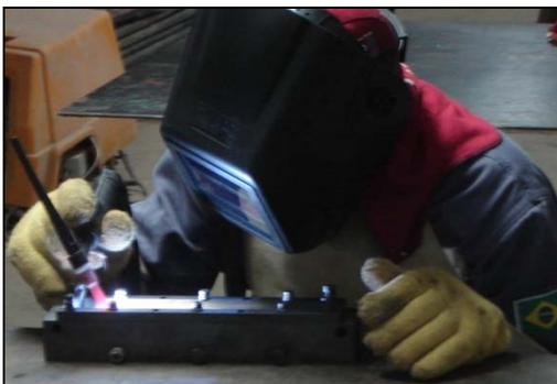
Figura 4.15. Soldagem do reforço, processo TIG
