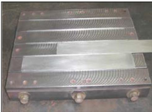
Figura 4.3. Colocação das chapas entre reforços
