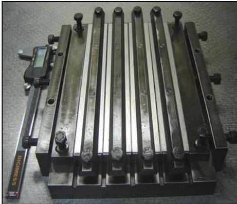
Figura 4.19. Posicionamento dos suportes no gabarito
