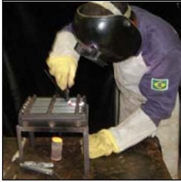
Figura 4.9. Soldagem através do processo TIG
