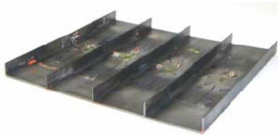
Figura 4.43. Modo de pós-colapso para o modelo experimental – modelo P2B
