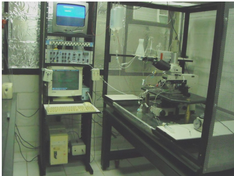
Figura IV.2: Setup proposto para aplicação da técnica de patch clamp . Na parte esquerda da figura pode ser notado o sistema de geração, aquisição e análise de sinais e, fontes de alimentação de todos os sistemas envolvidos enquanto à direita, inseridos em uma gaiola de Faraday, encontra-se o sistema de controle, aquisição de imagens e soluções empregadas nas culturas.
