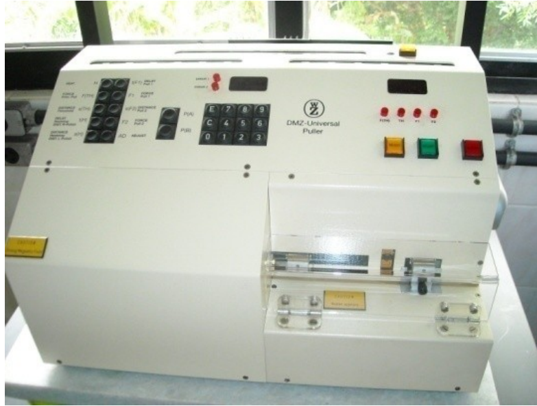
Figura IV.8- Puxador de pipetas horizontal (DMZ – Zeitz Instruments, Germany). Modelo empregado na fabricação de pipetas utilizadas em nossos experimentos.
